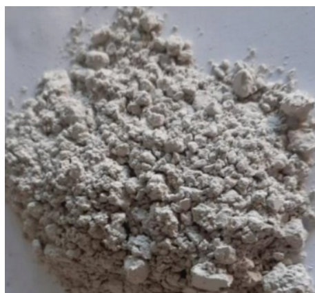
Slika 15. Granulirana zgura iz visoke peći [7]
