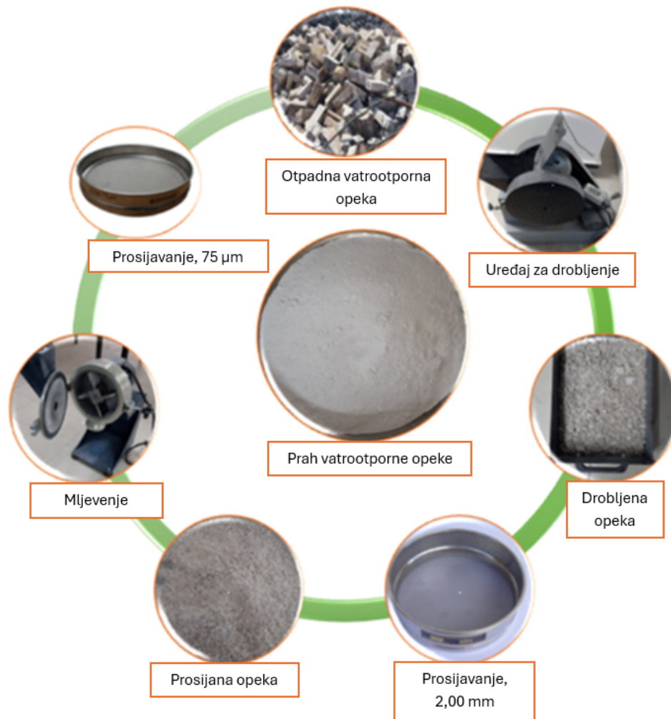
Slika 17. Proces pripreme prekursora od otpadne opeke za alkalnu aktivaciju [72]
