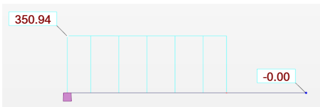
Slika 56.: Poprečna sila konzolnog nosača
