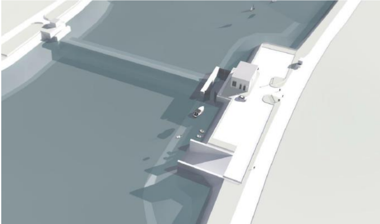
Slika 38: Grafički prikaz planirane potopljene brane i pripadne brodske prevodnice te kompresorske stanice (Izvor: [10] Domagoj Vranješ i suradnici: Elaborat zaštite okoliša u postupku ocjene o potrebi procjene utjecaja na okoliš za zahvat: Izmjena sustava navodnjavanja Donja Neretva, podsustav Opuzen - povećanje brodske prevodnice na mobilnoj pregradi na rijeci Neretvi, Vita projekt d.o.o., Zagreb, 2019.)
