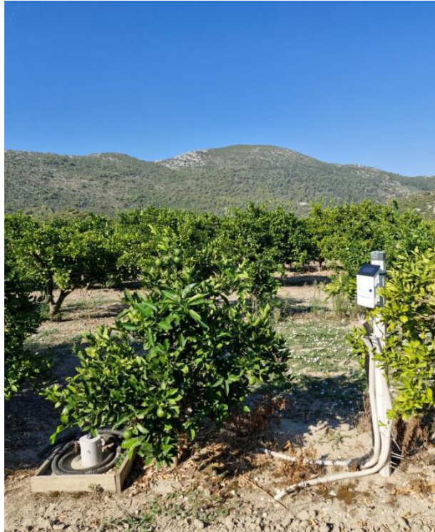
Slika 19: Monitoring tla i plitki piezometar ,P3/Pz3 (Izvor: DHMZ)
