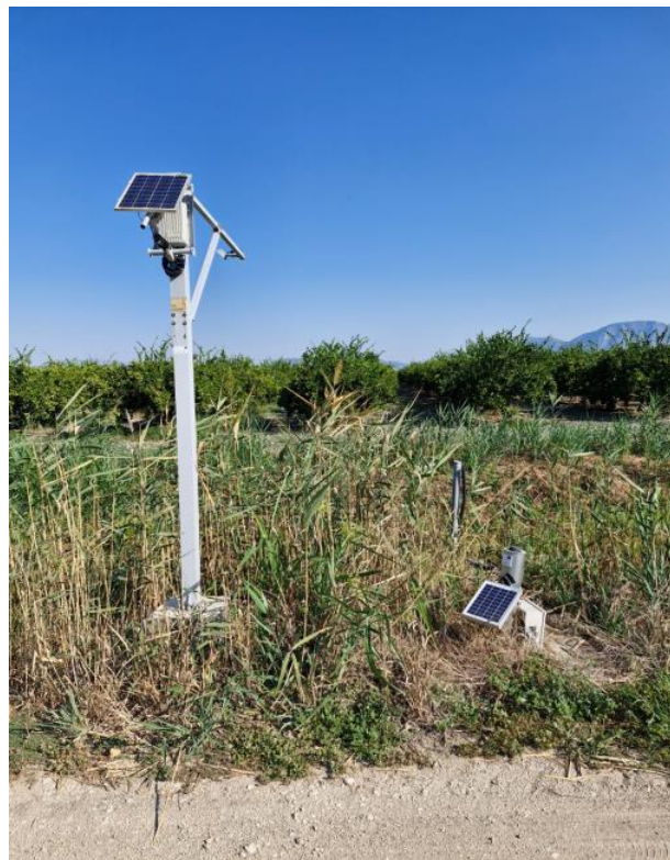
Slika 20: Monitoring tla i plitki piezometar ,P3/Pz3 (Izvor: DHMZ)
