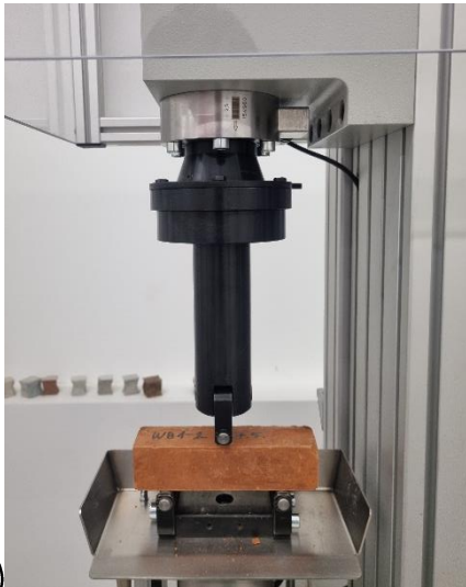
Slika 34: a) Uzorak WB u preši
