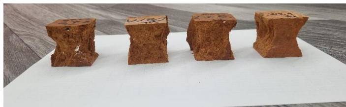
Slika 38: Izgled loma uzoraka WB nakon ispitivanja tlačne čvrstoće
