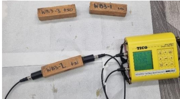
Slika 33: Mjerenje brzine prolaska ultrazvuka
