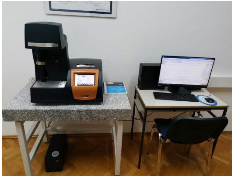
Slika 39: Uređaj za termogravimetrijsku analizu [74]
