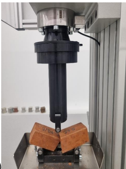
Slika 35: a) Uzorak WB u preši nakon loma
