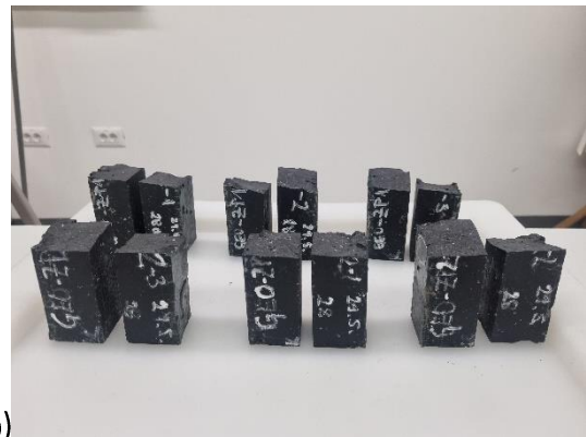
b) Uzorci ZP nakon ispitivanja
