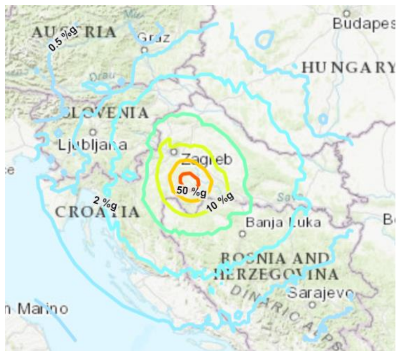
Slika 3. Vršno ubrzanje tla (PGA) za petrinjski potres
