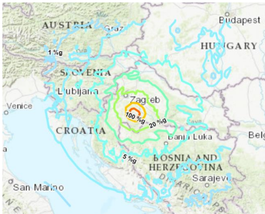
Slika 5. Vršno spektralno ubrzanje (PSA) za T=0.3s
