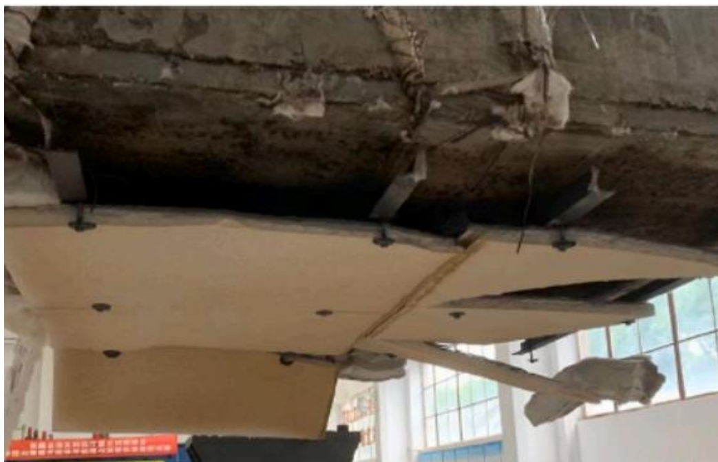
Slika 38. Uzorci za ispitivanje svojstava zaštitnih ploča na bazi kalcijevog silikata i vermikulita pri izlaganju djelovanju visokih temperatura [100]
