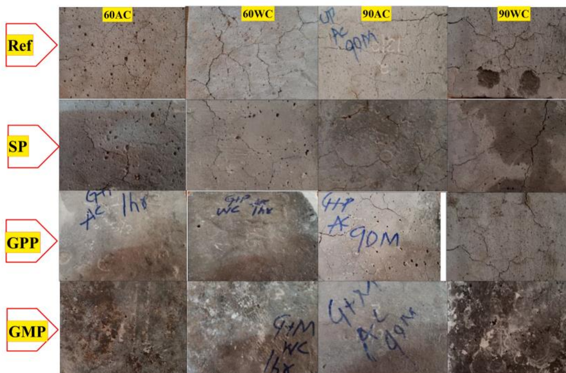
Slika 31. Izgled površine uzoraka različitih mješavina nakon zagrijavanja i hlađenja [85]
