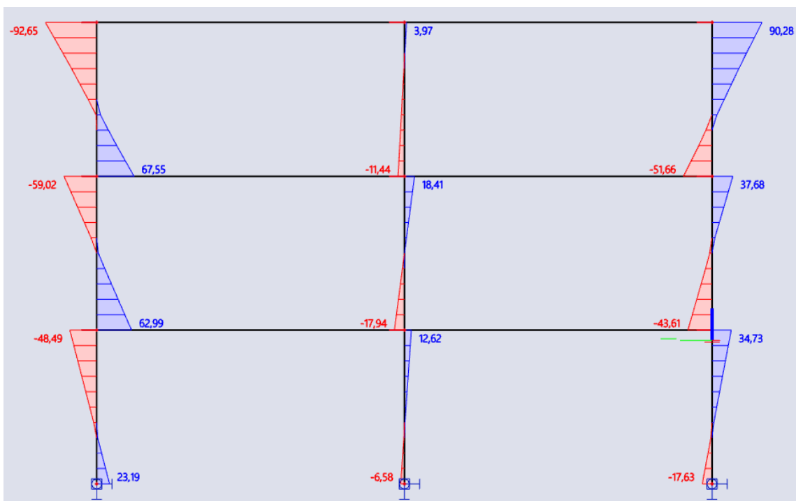
Slika 16: Dijagram momenata savijanja u stupovima za GSN
