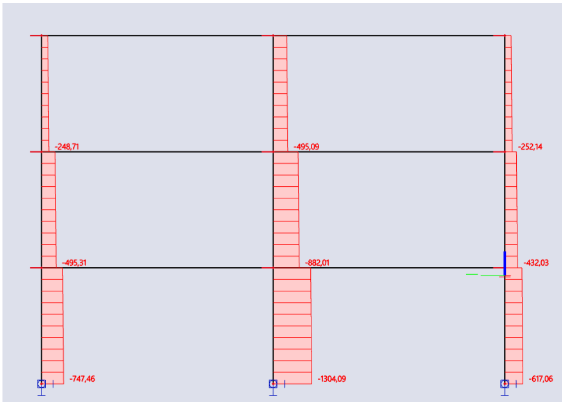
Slika 14: Dijagram uzdužnih sila u stupovima za GSN
