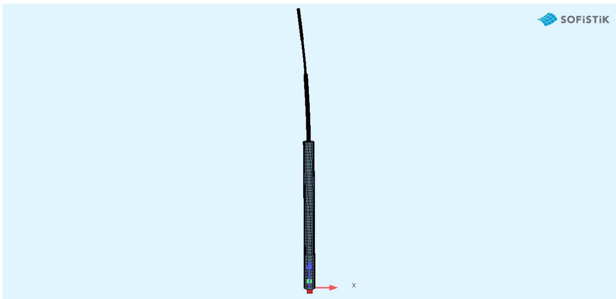
Slika 23.: Prvi oblik titranja (translacija u X smjeru)
