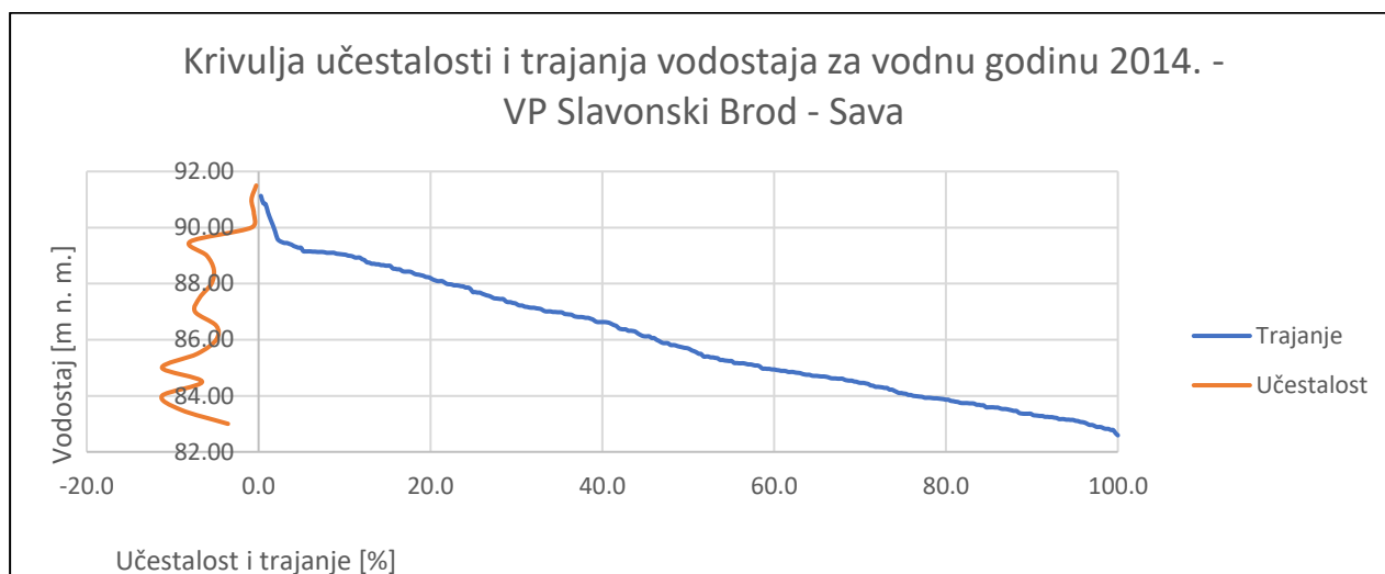
Slika 8. Krivulje učestalosti i trajanja protoka (kišna godina) – vodomjerna postaja Slavonki Brod
