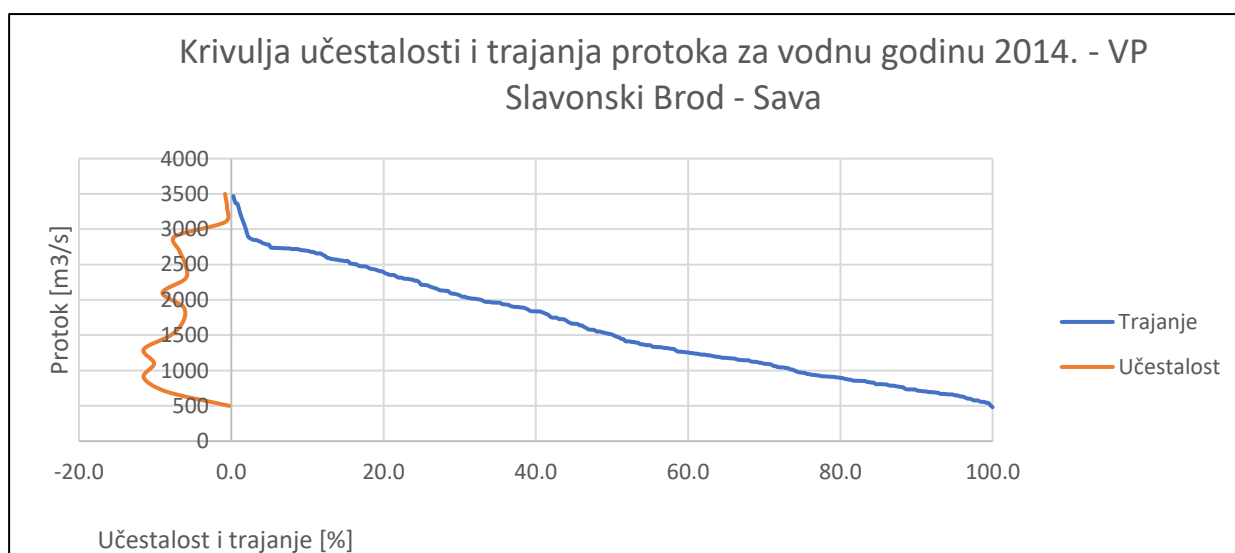
Slika 6. Krivulje učestalosti i trajanja protoka (kišna godina) – vodomjerna postaja Slavonski Brod
