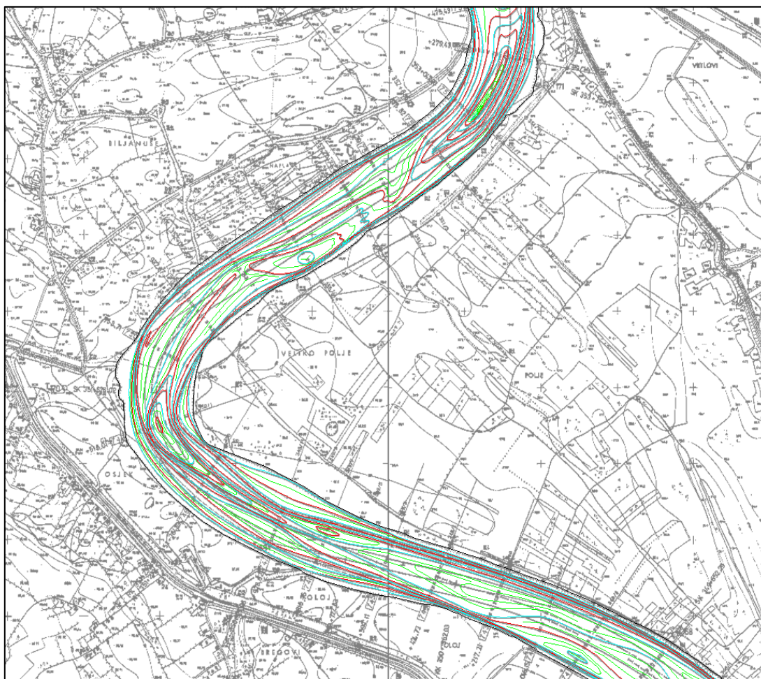
Slika 25. Detaljna batimetrija korita rijeke Save od rkm 362+488 do rkm 367+710
