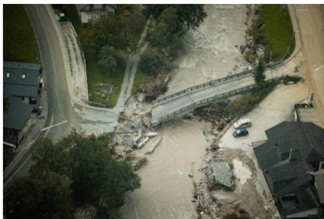
Slika 5. Urušavanje mosta u Godiču kod Kamnika
