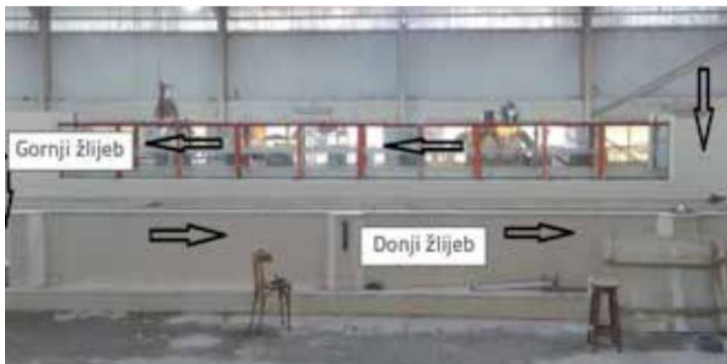
Slika 10 Model kanala u kojem se provodilo istraživanje
