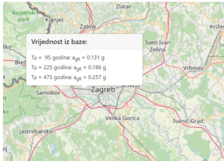
Slika 26 Vrijednosti horizontalnih vršnih ubrzanja tla za povratne periode 95, 225 te 475 godina (Izvor[14])
