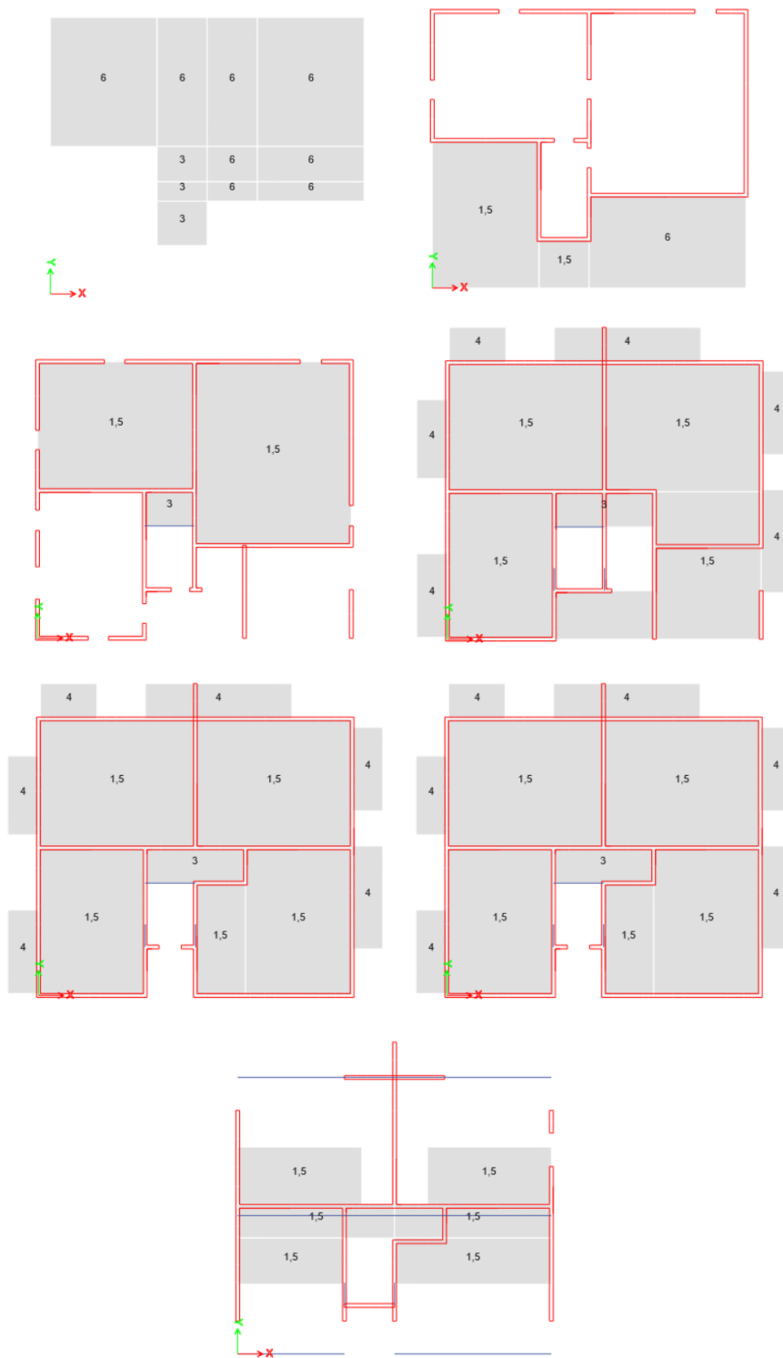
Slika 31 Prikaz korisnog djelovanja na ploče redom od podruma do galerije
