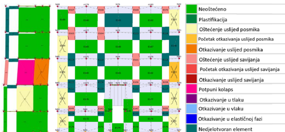
Slika 43 Oštećenja zida 17 i 6 za analizu 19 s legendom oštećenja
