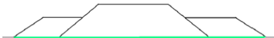
Slika 45: Izrada nasipa bočnim nasipima (Izvor: [8])
