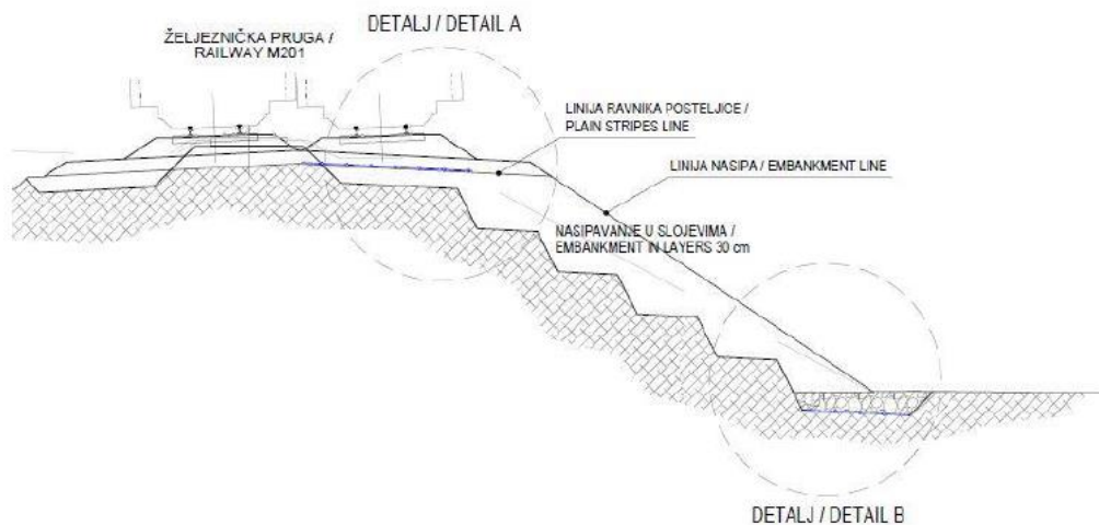
Slika 16 Iskop za proširenje postojećeg nasipa(HŽ infrastruktura, 2022.)
