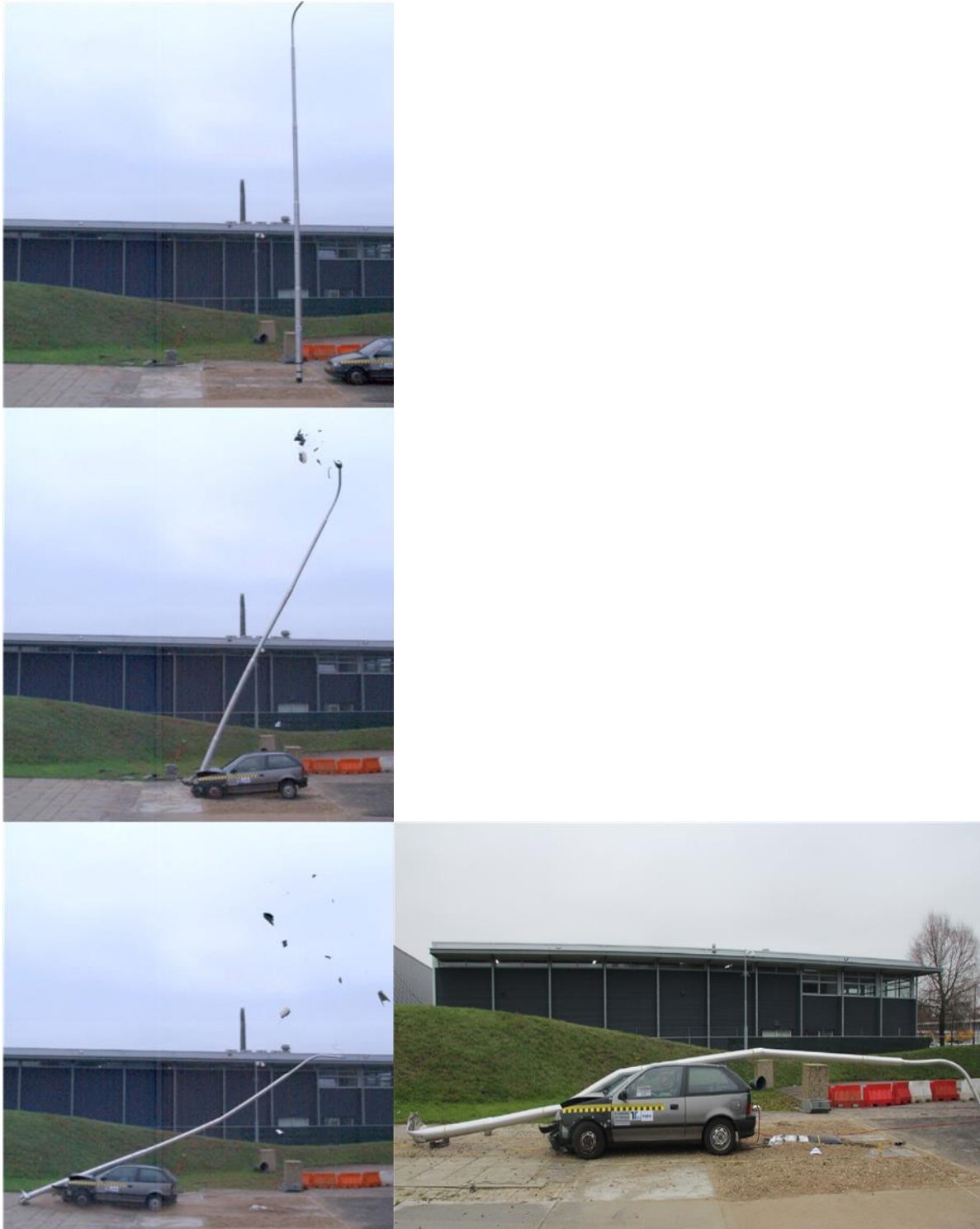
Slika 4.2. Pokusni sudar s visokoapsorbirajućim stupom [16]
