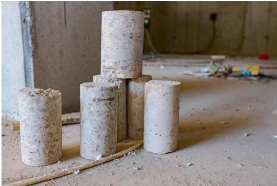
Slika 15.: Uzimanje uzoraka betona [15]
