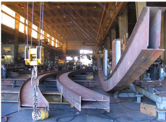
Slika 3.3. Čelična zakrivljena greda [10]
