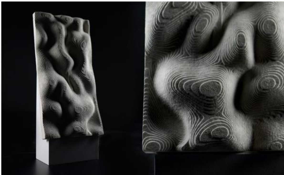
Slika 31: Primjer oblikovanja betona ledenom oplatom (Izvor [8.]
