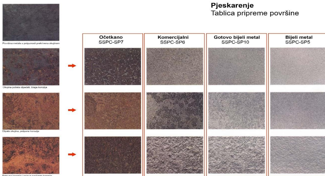
Slika 28.: Prikaz različitih stanja površine prema NACE-u (Izvor:[10])
