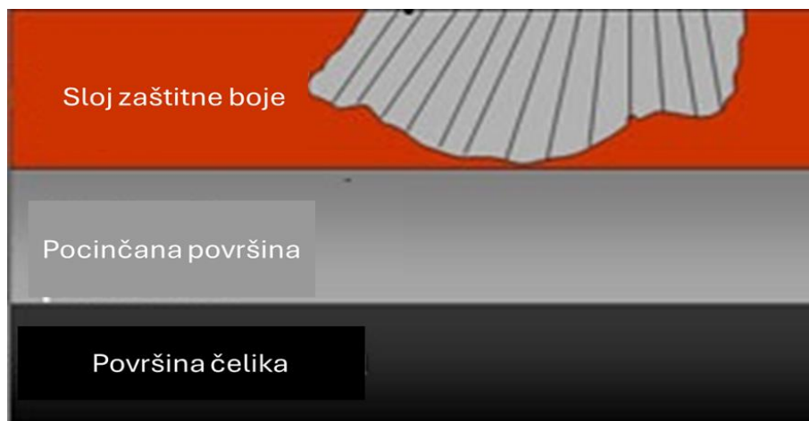
Slika 16.: Shematski prikaz dupleksnog sustava (Izvor: [15])
