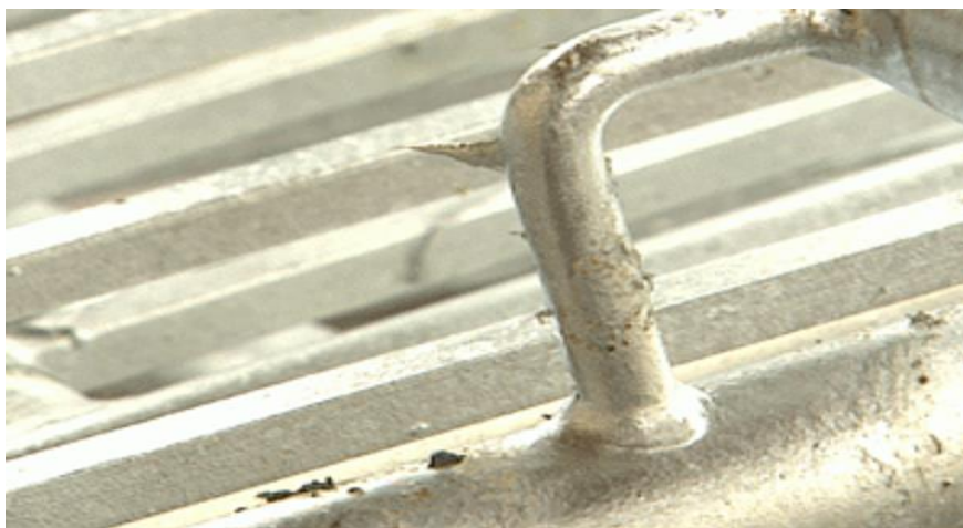
Slika 17.: Izbočine i mrlje na pocinčanom čeliku (Izvor: [23])
