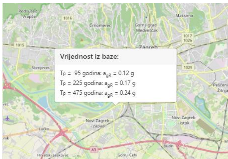
Slika 3.3.11. Prikaz povratnih perioda i ubrzanja tla za odabranu lokaciju
