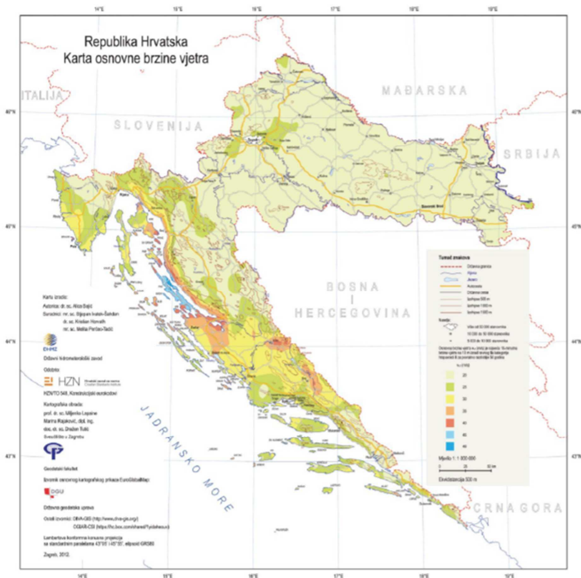
Slika 3.4.: Karta osnovnih brzina vjetra v_{b,0} (Izvor: [2])
