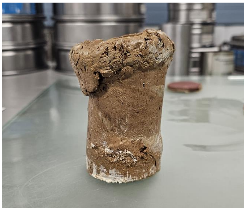
Slika 33. Razlomljeni uzorak nakon ispitivanja kod UU pokusa
