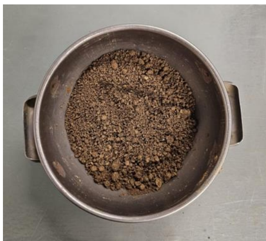
Slika 10. Potpuno poremećen uzorak tla u stanju prirodne vlažnosti i konzistencije
