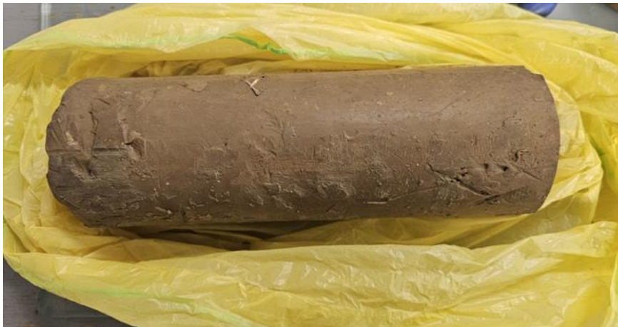
Slika 6. Neporemećeni istisnuti uzorak iz cijevi za uzorkovanje
