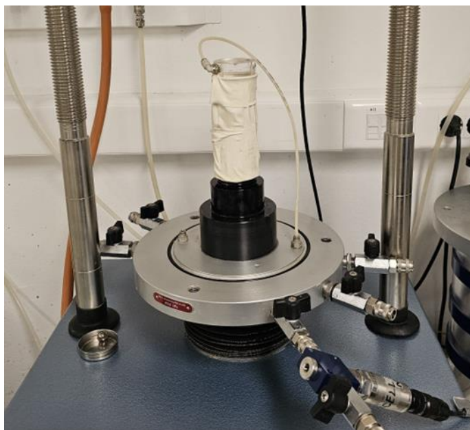
Slika 31. Uzorak obavijen membranom pripremljen za ispitivanje UU pokusom
