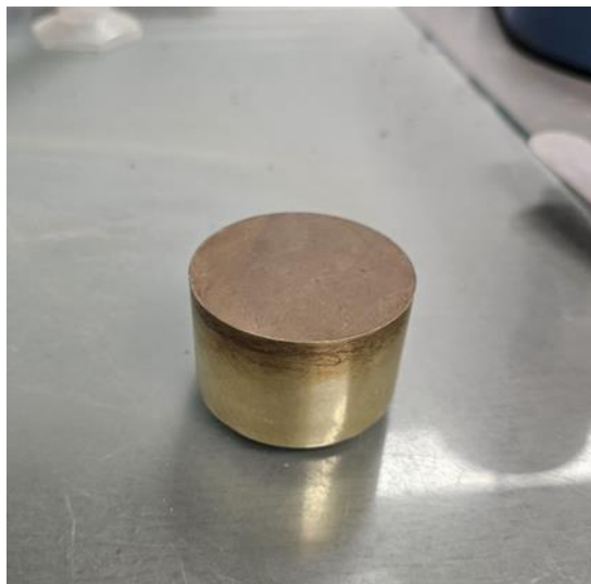
Slika 11. Potpuno poremećeni uzorak tla spreman za ispitivanje
