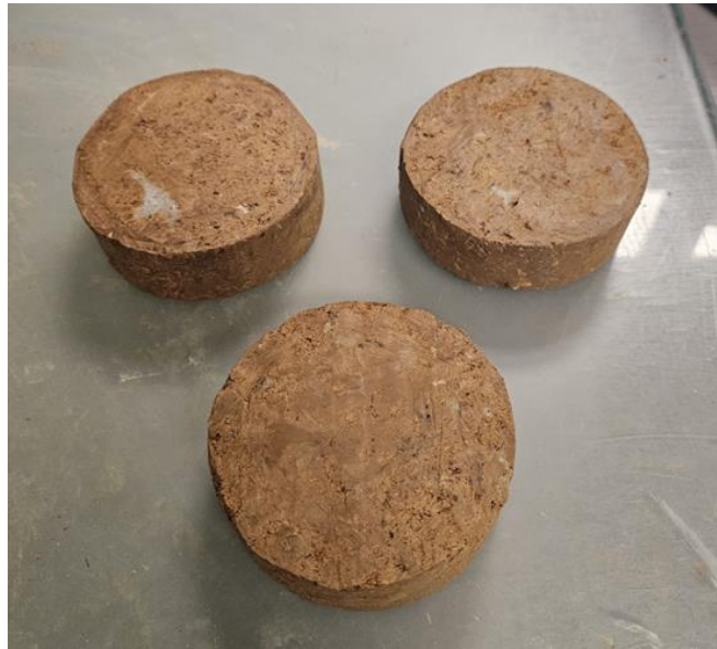
Slika 7. Neporemećeni uzorci pripremljeni za ispitivanje
