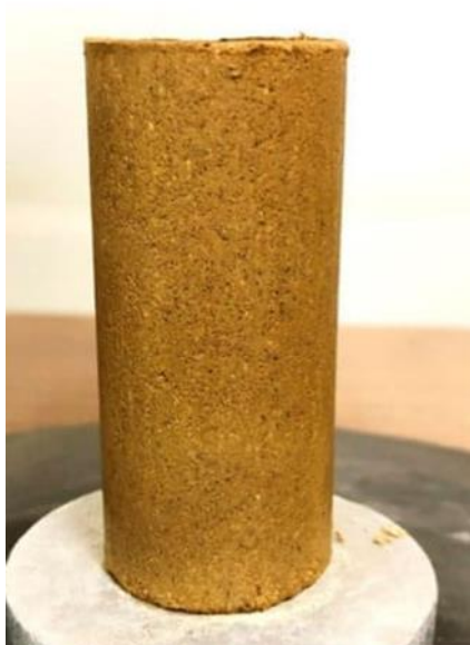
Slika 17. Uzorak tla pripremljen za pokus jednoosnog tlaka [17]
