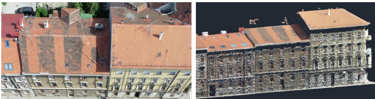
Slika 47. (a) Prikaz s RGB kamere; (b) oblak točaka (LIDAR)
