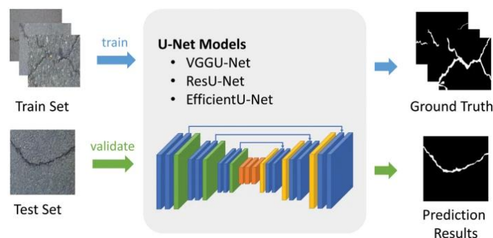
Slika 20: Detekcija pukotina primjenom U-Net alata (26)
