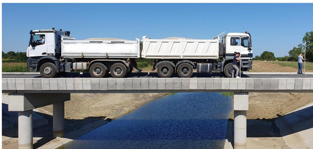
Slika 31.: Faza 4 – položaj kamiona za postizanje maksimalnog pomaka u srednjem rasponu
