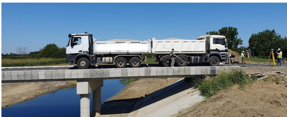
Slika 66.: Statičko ispitivanje mosta kamionima – mjerenje vertikalnih pomaka u FAZI 4 (gore) i FAZI 5 (dolje)
