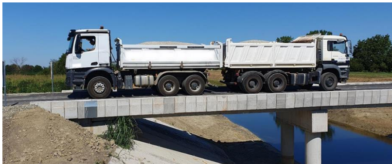
Slika 65.: Statičko ispitivanje mosta kamionima – mjerenje vertikalnih pomaka u FAZI 2 (gore) i FAZI 3 (dolje)
