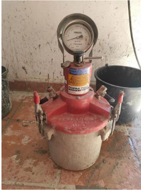
Slika 8. Porometar za određivanje sadržaja zraka
