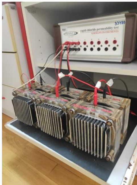
Slika 11. Čelije s uzorcima spojene na potencijostat
