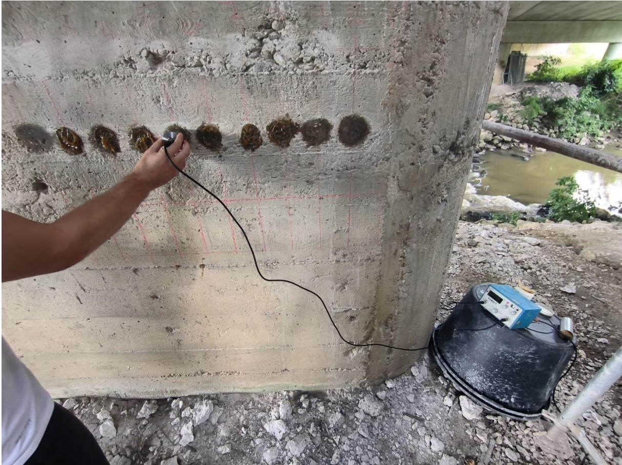
Slika 43. Prva faza ispitivanja ultrazvukom
