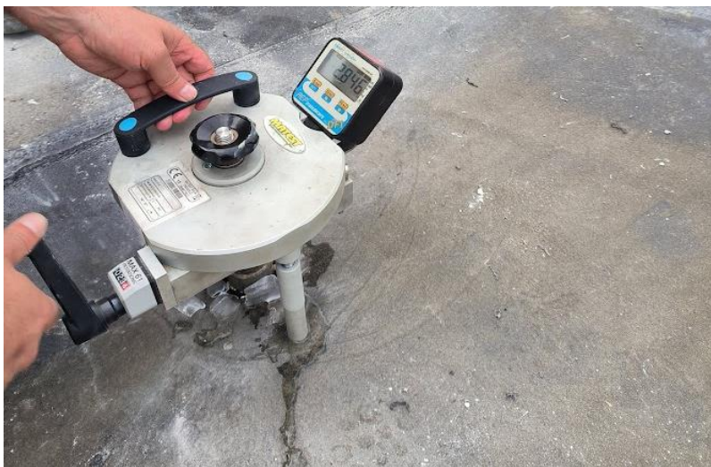
Slika 27. Primjer ispitivanja vlačne čvrstoće pull-off metodom
