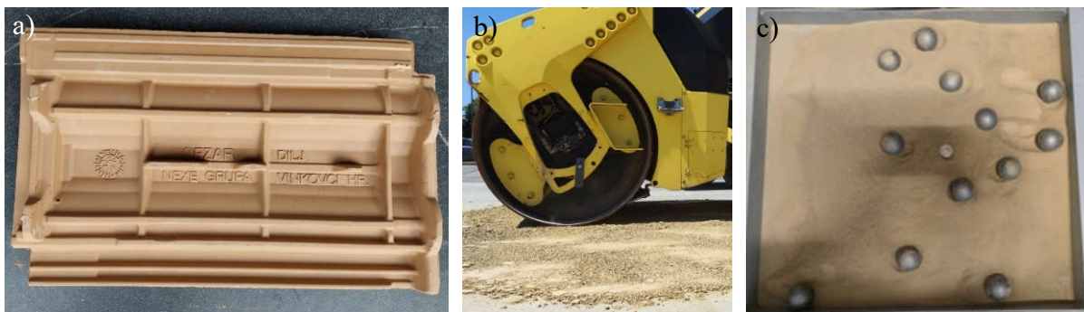
Slika 6-16 Dodani sitnozrnati materijal: a) nepečeni crijep; b) usitnjavanje valjkom s glatkim čeličnim kotačima; c) usitnjavanje u uređaju za provođenje Los Angeles pokusa
