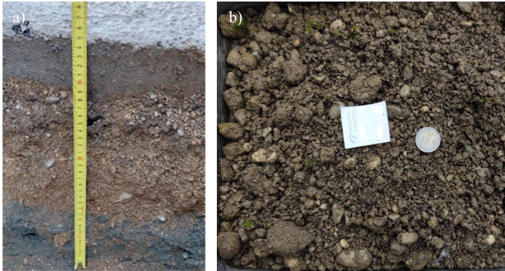
MNS na lokaciji 3: a) debljina sloja; b) materijal izvađen iz sloja
