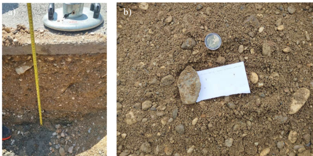
MNS na lokaciji 16: a) debljina sloja; b) materijal izvađen iz sloja
