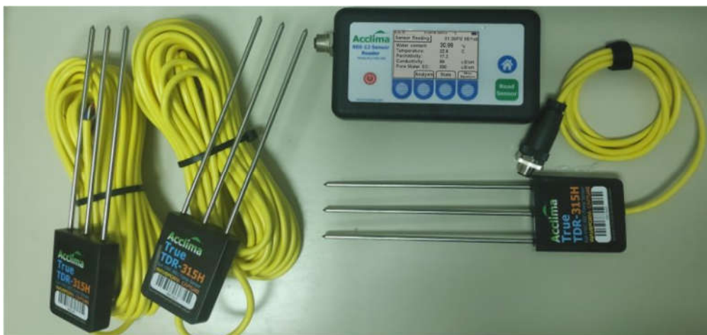
Slika 5-1 Prikaz sastavnih komponenti TDR-a
