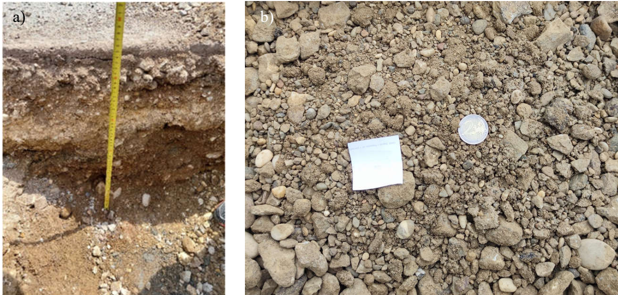
MNS na lokaciji 30: a) debljina sloja; b) materijal izvađen iz sloja
