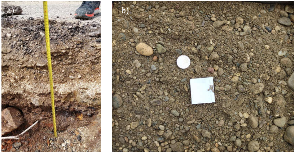
MNS na lokaciji 29: a) debljina sloja; b) materijal izvađen iz sloja
