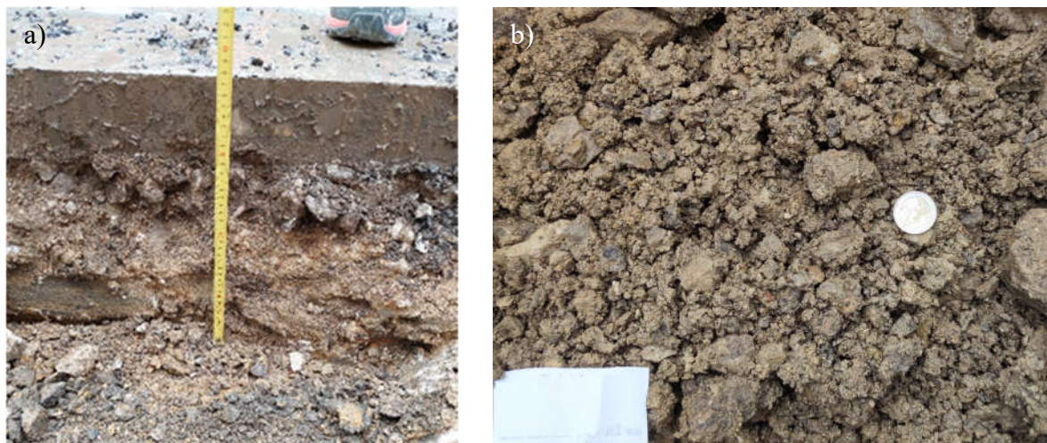
MNS na lokaciji 21: a) debljina sloja; b) materijal izvađen iz sloja
