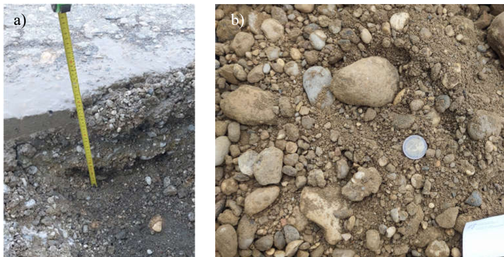
MNS na lokaciji 8: a) debljina sloja; b) materijal izvađen iz sloja
