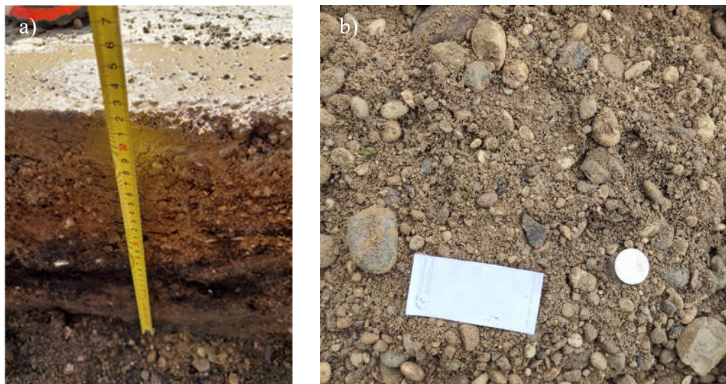
MNS na lokaciji 25: a) debljina sloja; b) materijal izvađen iz sloja
