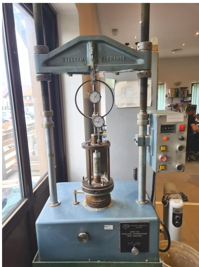
Slika 7.3. Uređaja za ispitivanje jednoosne tlačne čvrstoće uzoraka u geotehničkom laboratoriju tvrtke GEOTEST d.o.o. iz Zagreba
