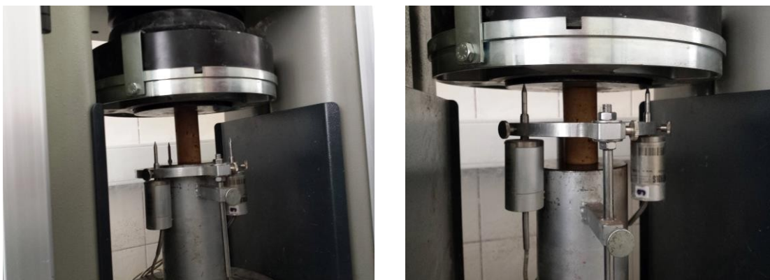
Slika 7.13. Umetanje uzorka na postolje uređaja i pozicioniranje LVDT
