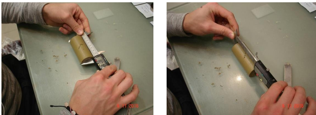
Slika 7.12. Mjerenje visine uzorka u dvije okomite ravnine
