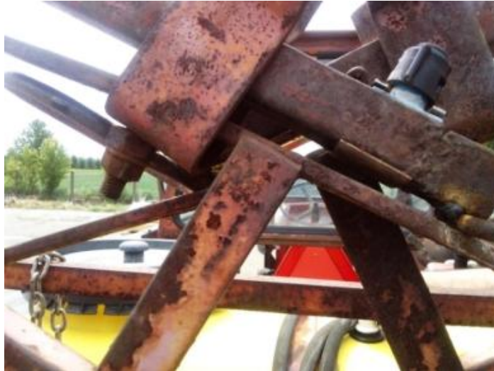
Slika 5.: Primjer neravnomjerne opće korozije [6]
