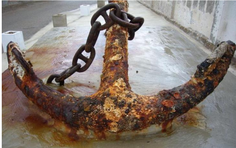
Slika 4.: Primjer elektrokemijske korozije [8]
