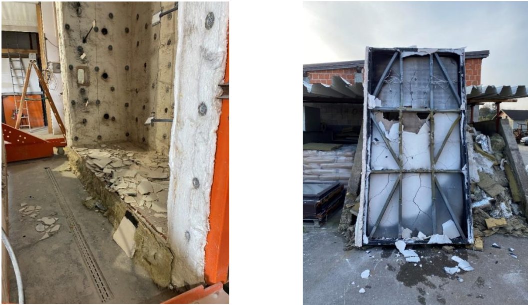
Slika 28: a) Komadići gips-vlaknastih ploča u peći nakon ispitivanja b) Uzorak izvađen iz peći
