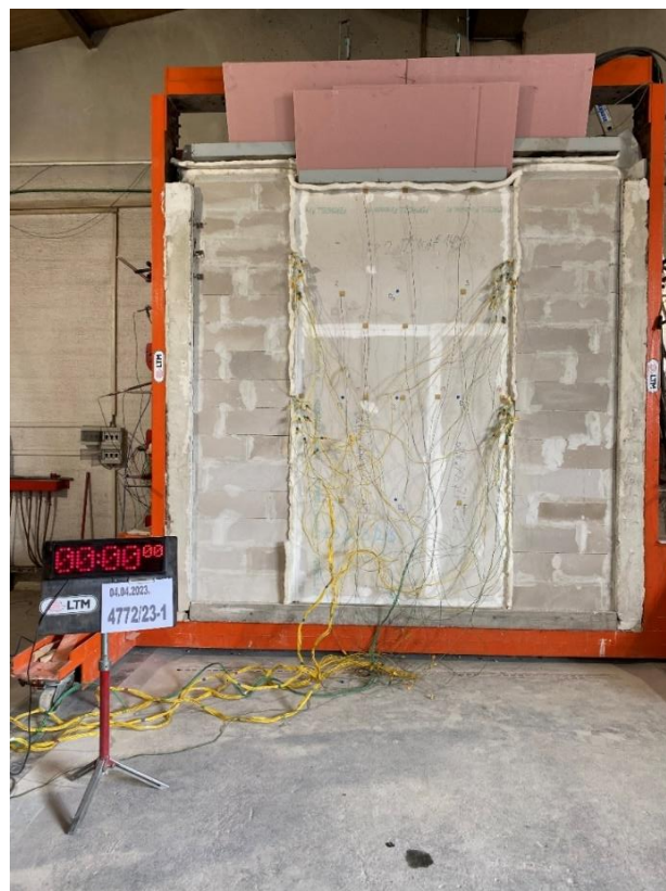
Slika 19: Uzorak panela ugrađen u okvir ispitne peći na početku ispitivanja
