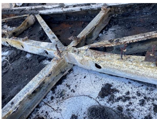
Slika 35: a) Izvijanje dijagonala na čvoru 11 nakon ispitivanja Panela 2 b) Čelični vijci nakon ispitivanja
