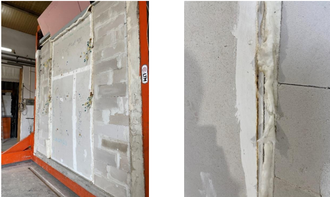
Slika 27: a) Deformacije neizložene strane Panela 1 nakon ispitivanja b) Detalj slobodnih rubova zida
