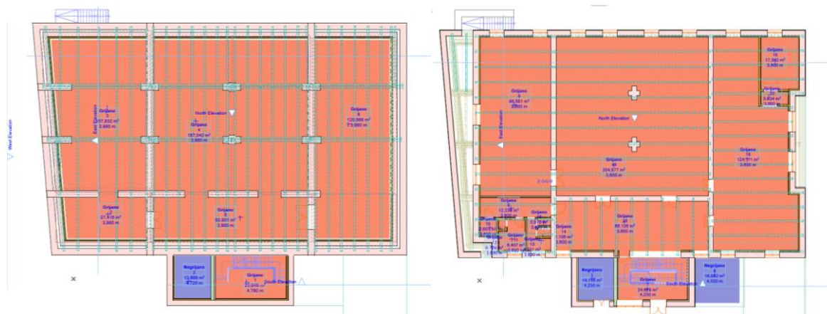
Slika 12 Tlocrt podruma (lijevo) i prizemlja (desno) s označenim grijanim i negrijanim prostorima
