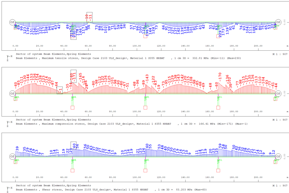
Slika 102. Najveća poprečna sila i pripadajući moment savijanja, SOFiSTiK
