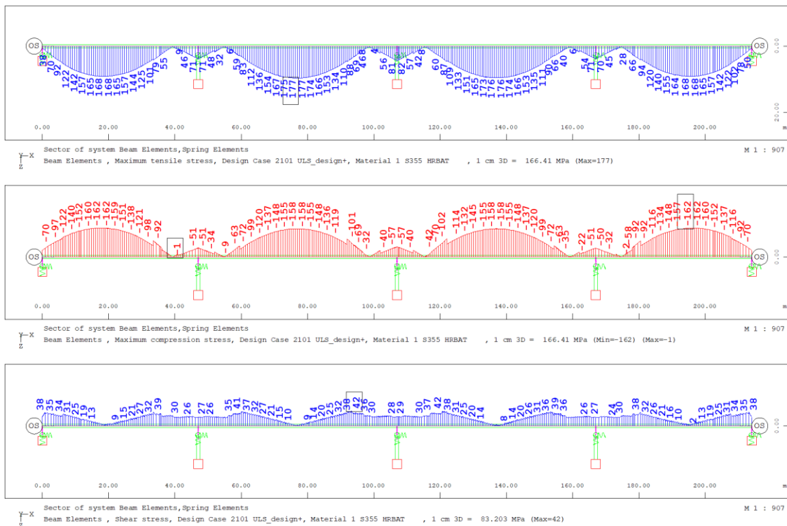
Slika 103. Najveća poprečna sila i pripadajući moment, SOFiSTiK
