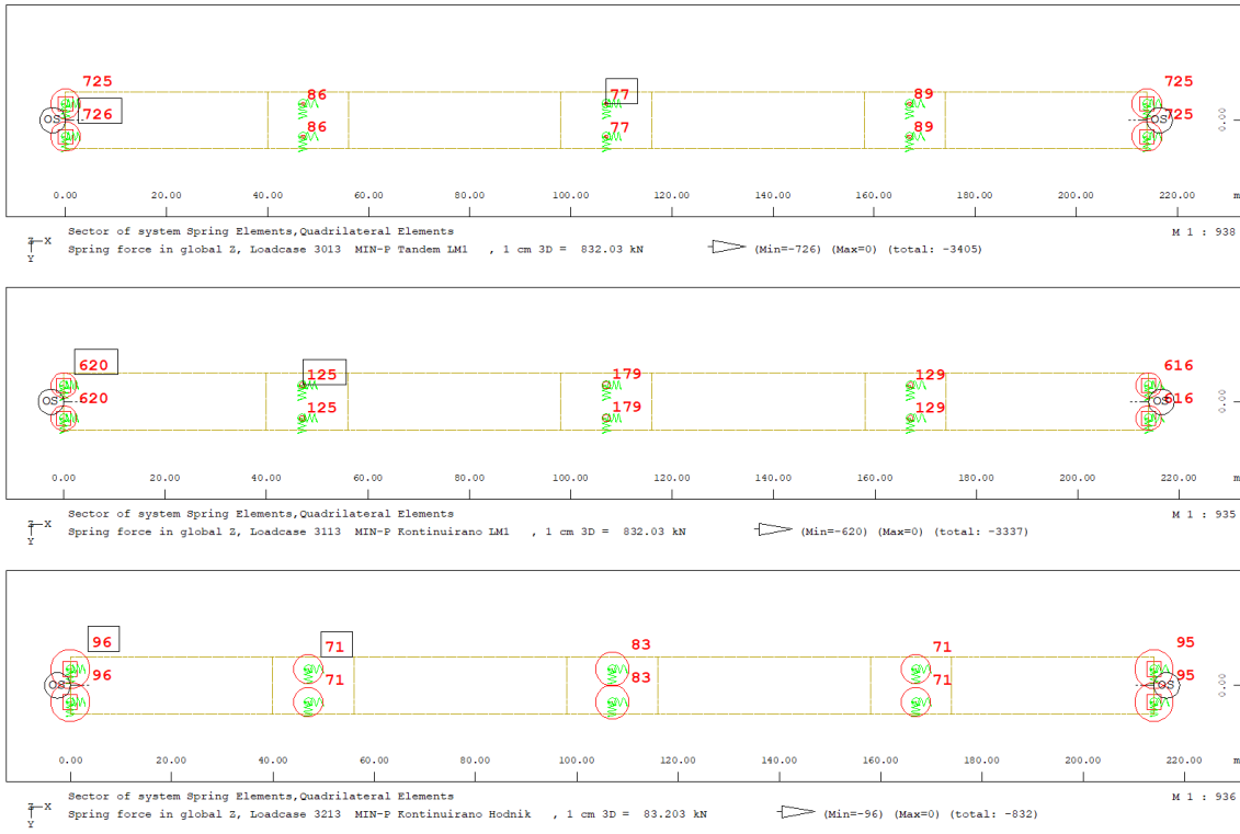
Slika 172. Vertikalna reakcija(minimalna), SOFiSTiK
