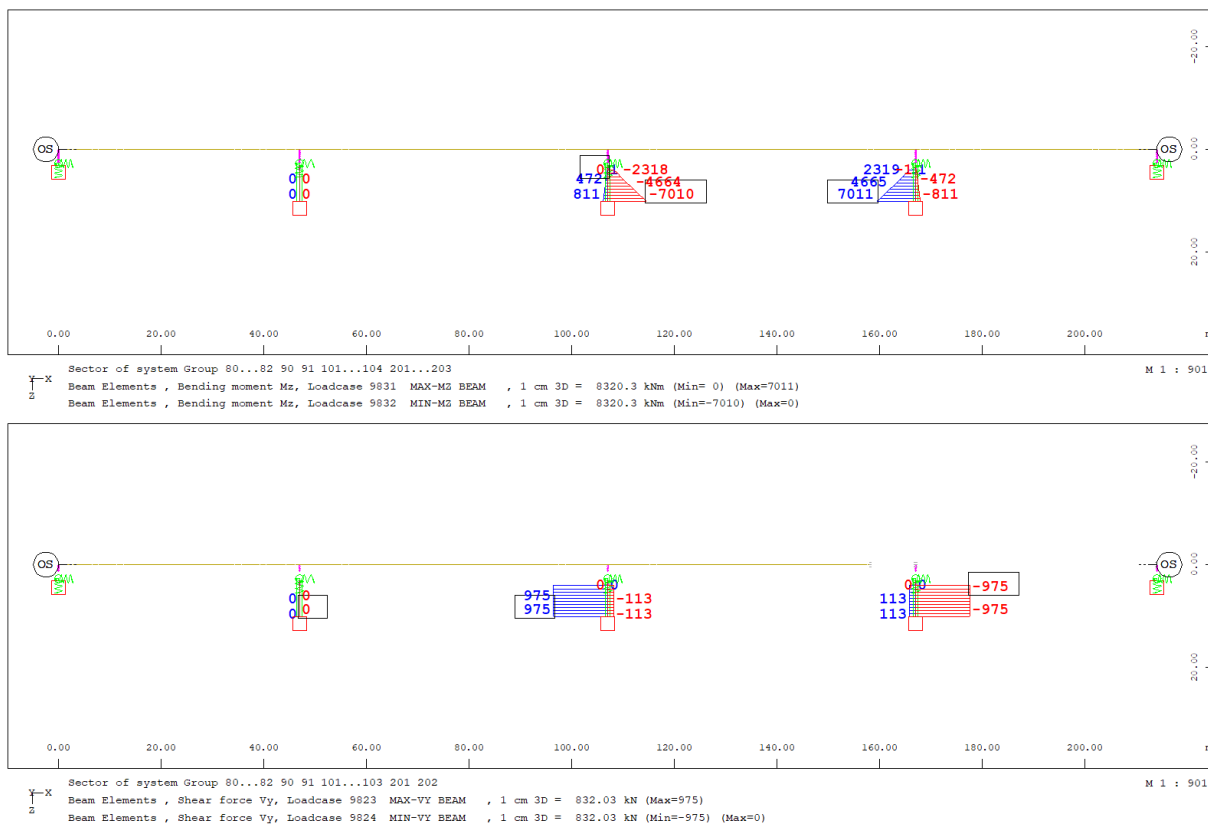
Slika 67. Moment savijanja i poprečna sila za stupove, SOFiSTiK
