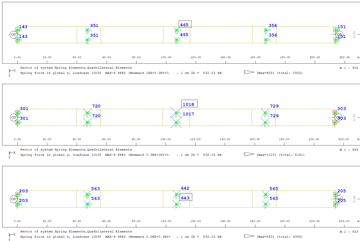
Slika 188. Vertikalna reakcija, SOFiSTiK
