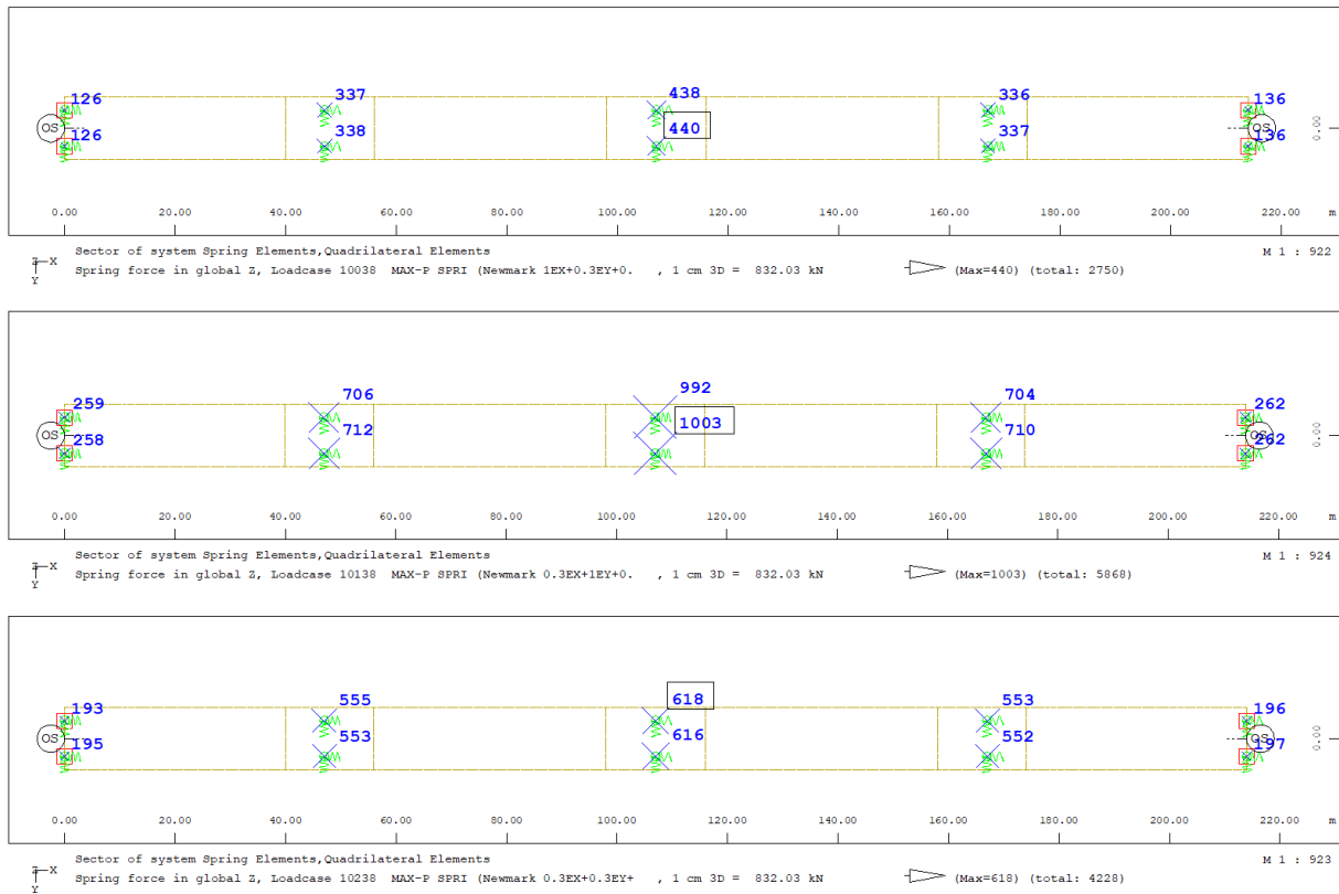
Slika 91. Vertikalna reakcija, SOFiSTiK
