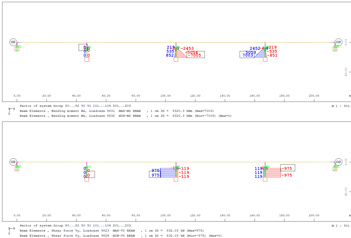
Slika 164. Moment savijanja i poprečna sila za stupove, SOFiSTiK
