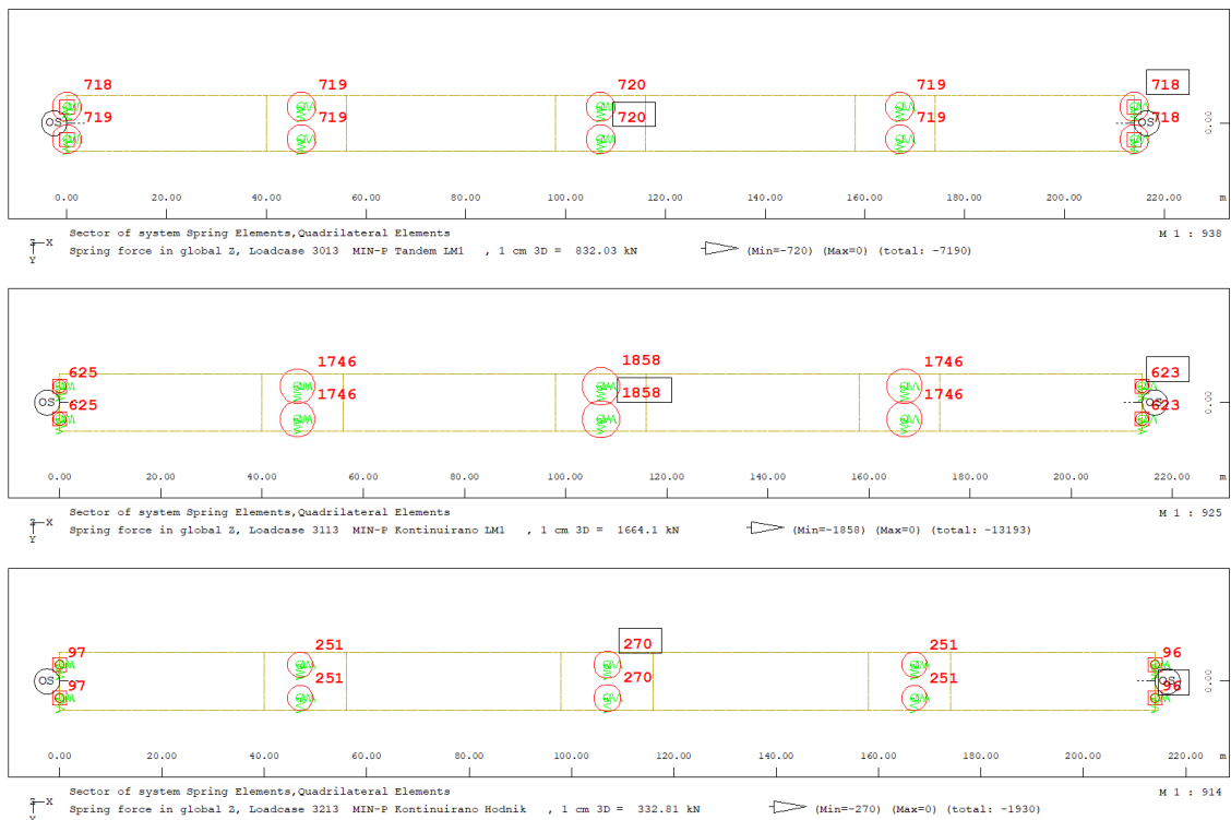
Slika 75. Vertikalna reakcija(minimalna), SOFiStiK
