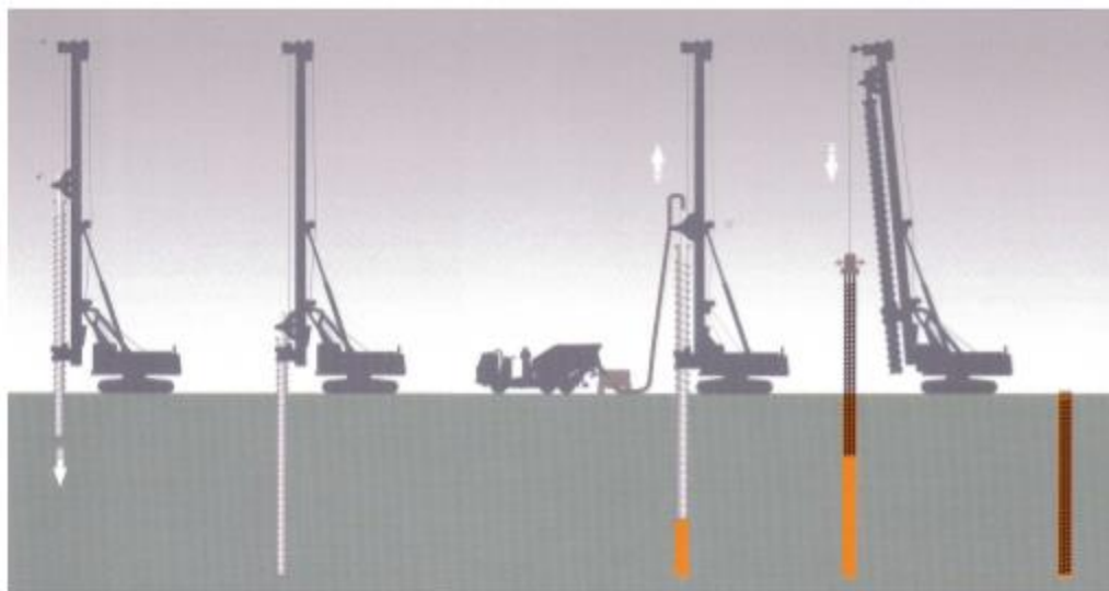
Slika 31. Shema iskopa svrdlom
