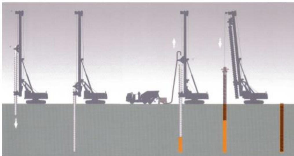
Slika 31. Shema iskopa svrdlom
