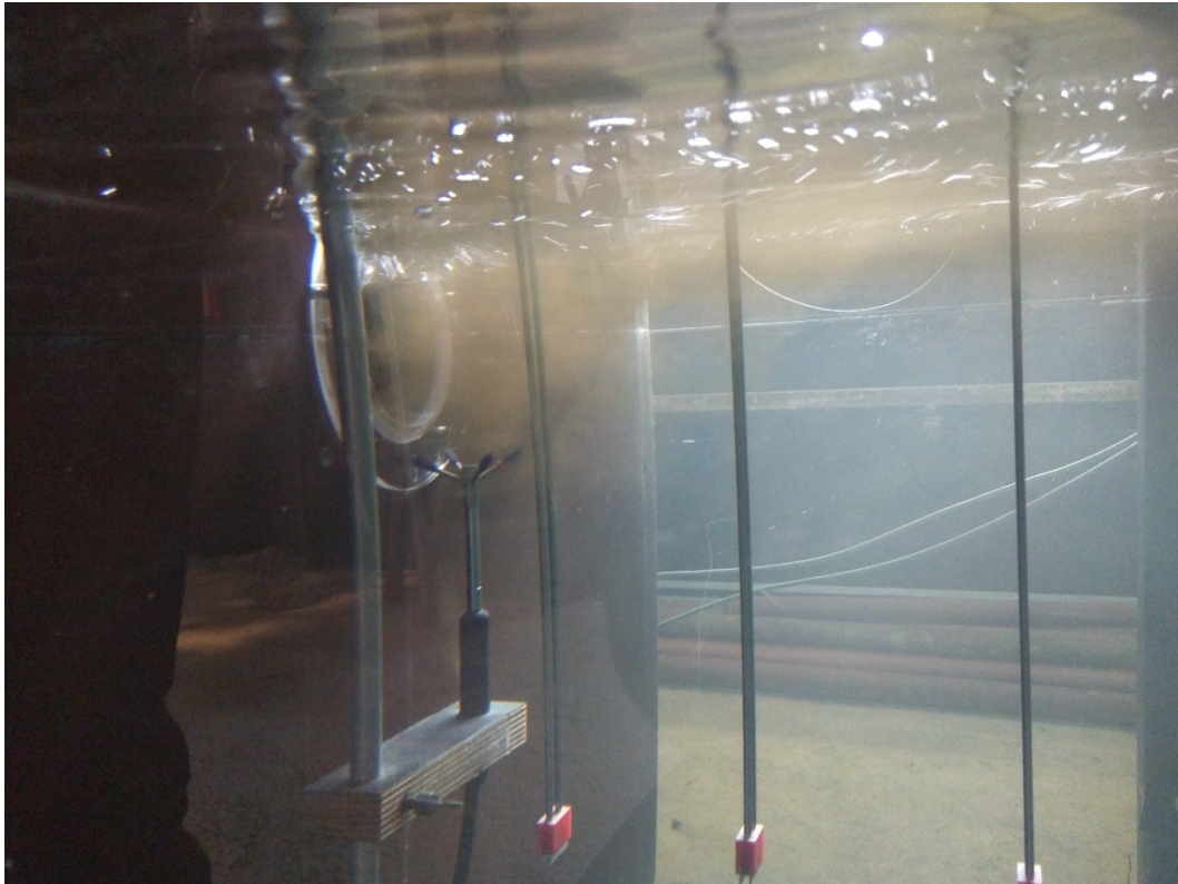
Slika 19 ADV uređaja za mjerenje brzine u točki i kapacitivne sonde G5, G6 i G7 za mjerenje valnih parametara na stražnjoj strani modela lukorana s ugrađenim potpuno uronjenim (razina W1) propustom kružnog poprečnog presjeka promjera koji iznosi 10 cm
