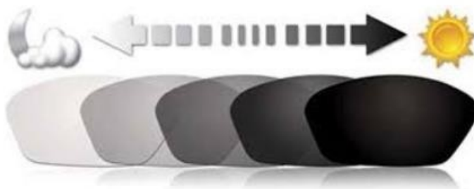
Slika 28: Princip rada fotokromatskog stakla
