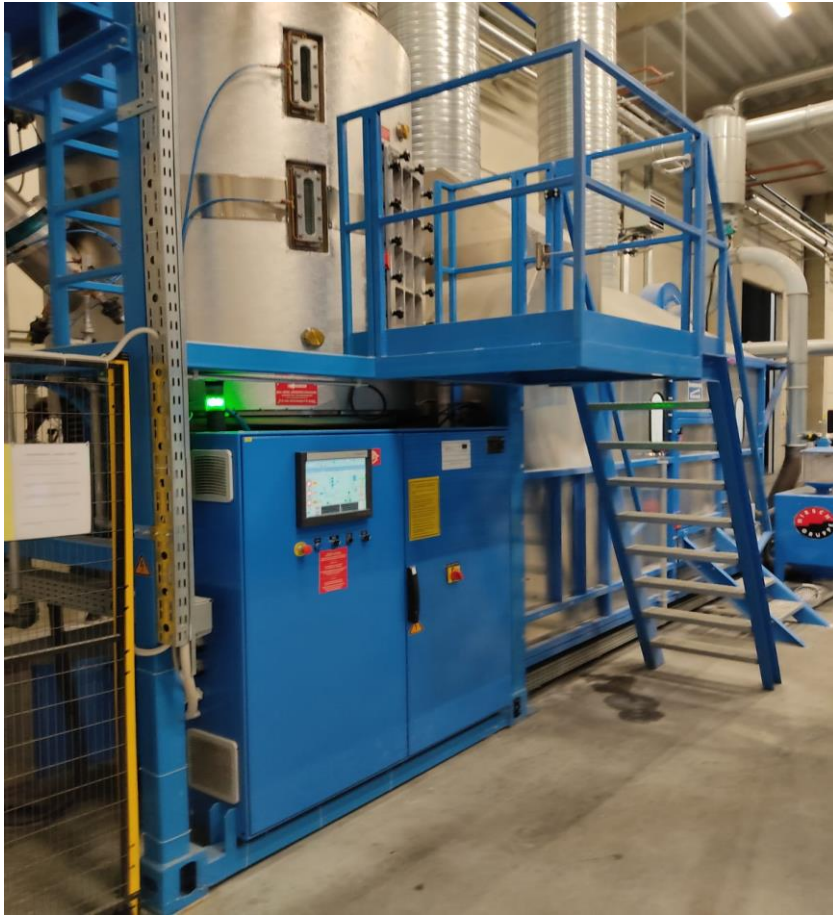
Slika 9 Vanjski izgled predekspandera
