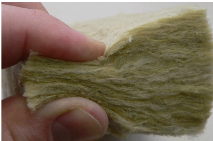
Slika 1 Prikaz presjeka mineralne vune (Wikipedia)
