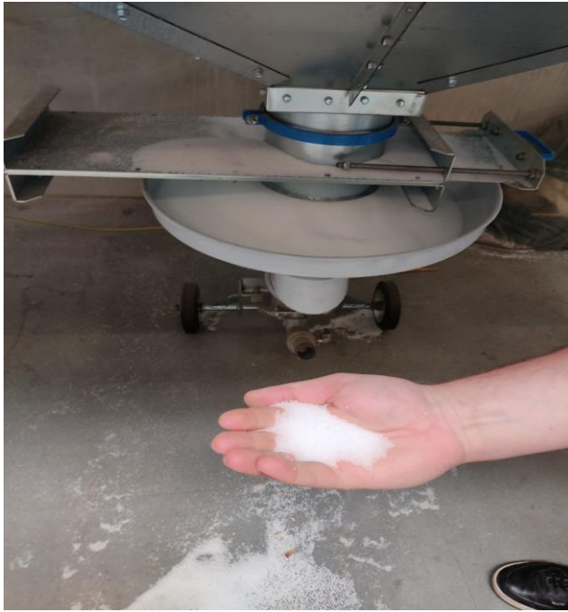
Slika 7 Sirovina polistiren na početku procesa proizvodnje
