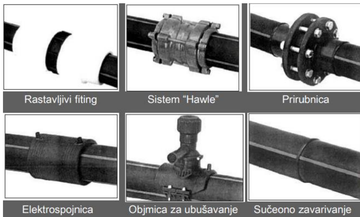
Slika 10. Načini spajanja PEHD cijevi [7]
