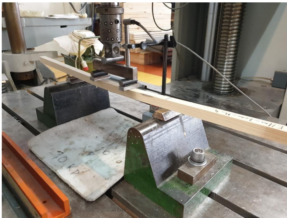
Slika 3.32 Početak ispitivanja – uzorak dimenzija 20 \times 20 mm
