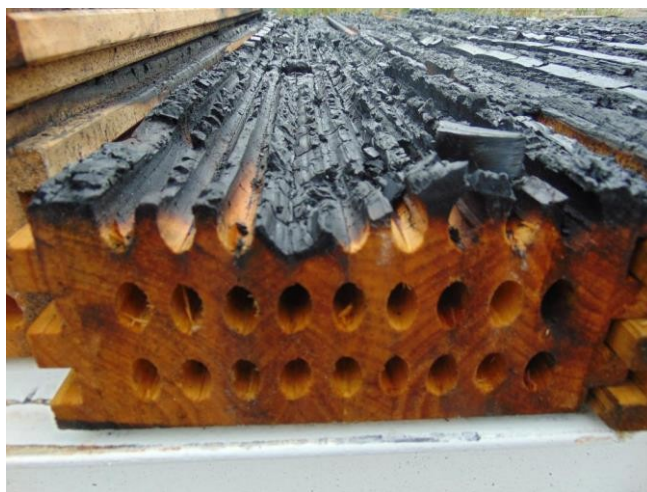
Slika 4.112 Presjek prošupljenog laminiranog drvenog elementa nakon ispitivanja
