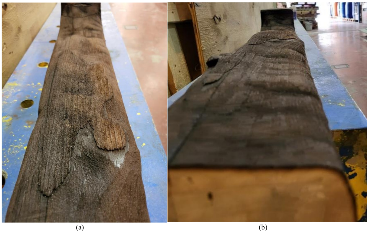
Slika 4.14 Uzorci pune grede; površine lijepljenja: (a) K. 501 ljepilo; (b) K. 510 ljepilo
