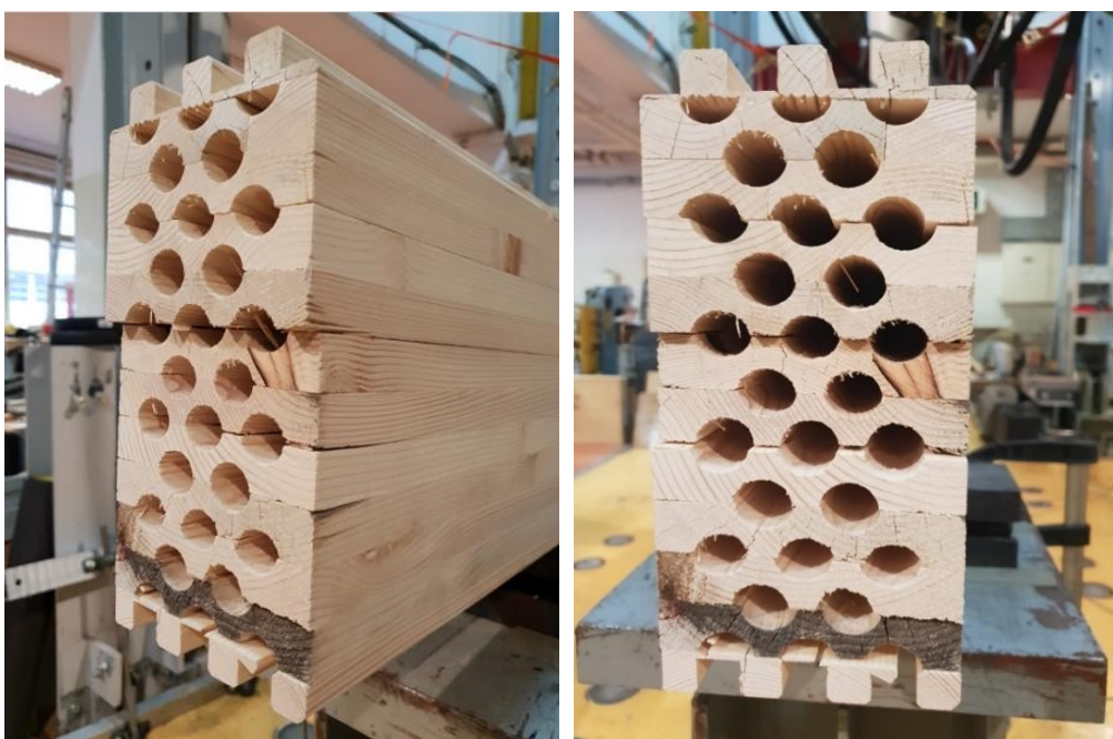
Slika 3.11 Poprečni presjek uzorka SK(0) - 1 nakon otkazivanja uzdužno po ljepilu
