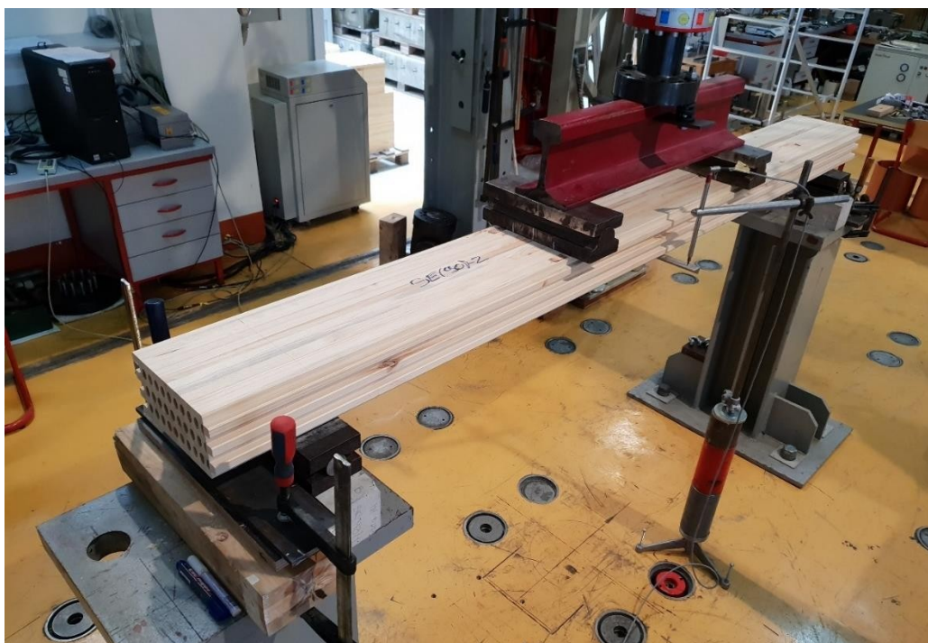
Slika 3.13 Ispitivanje uzoraka savijanjem oko slabije osi - položaj na preši
