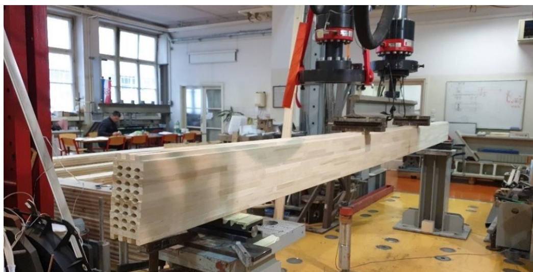
Slika 3.36 Ispitivanje grede savijanjem oko jače osi
