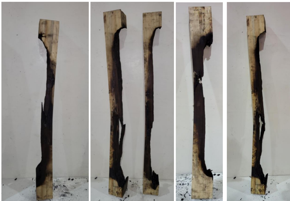
Slika 4.15 Modovi loma prošupljenih uzoraka
