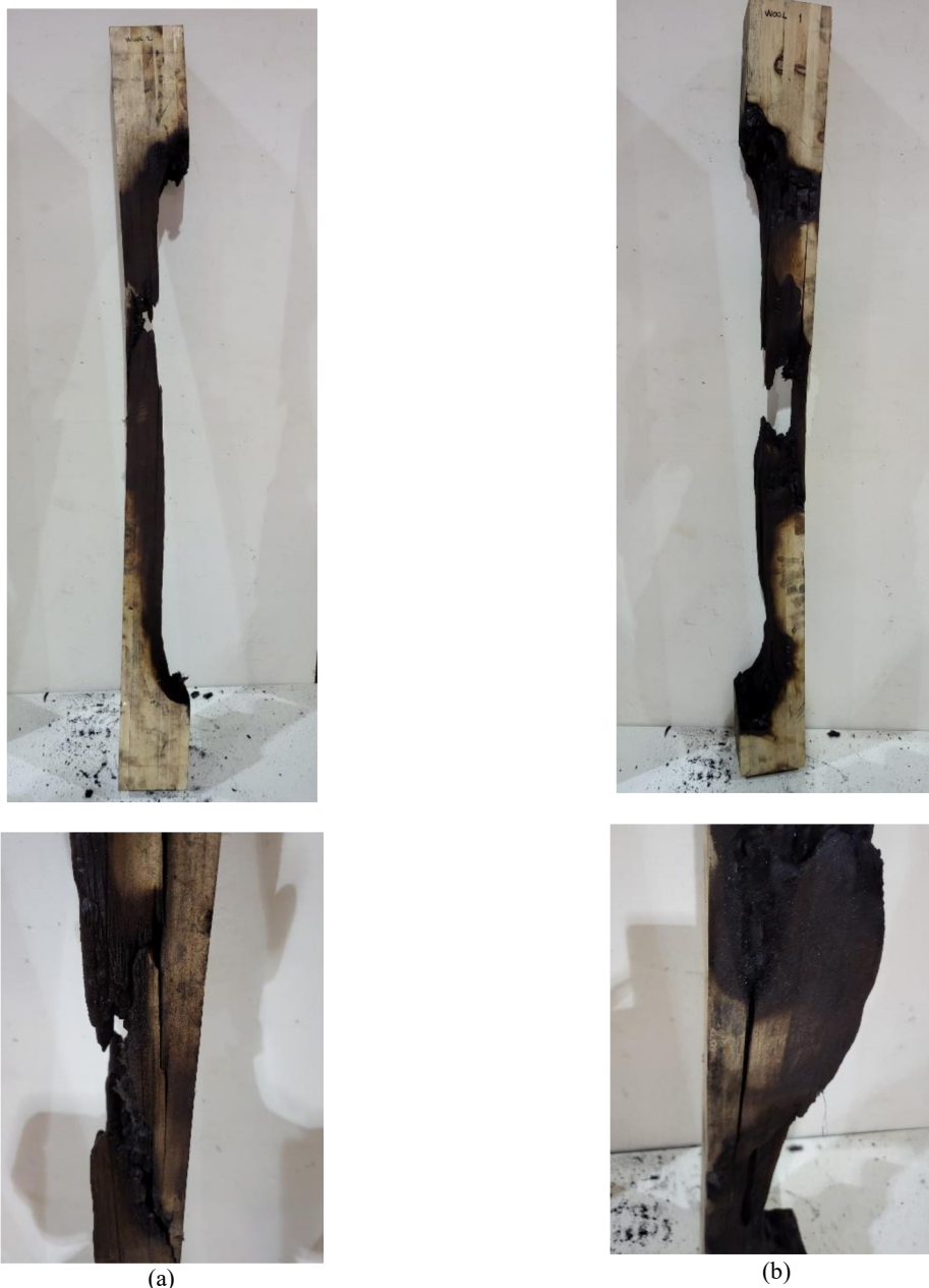
Slika 4.17 Modovi loma prošupljene grede sa kamenom vunom: (a) K.501; (b) K.510
