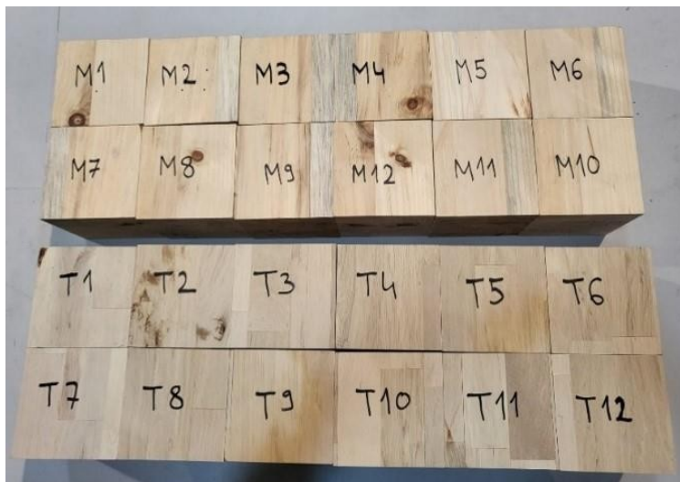
Slika 3.34 Uzorci za ispitivanje gustoće i vlage
