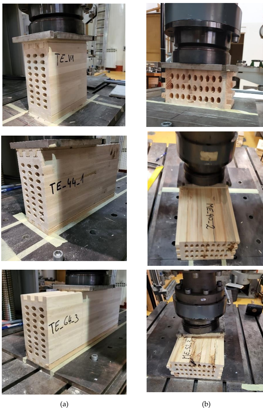
Slika 3.51 Unos opterećenja: (a) u smjeru jače osi; (b) u smjeru slabije osi
