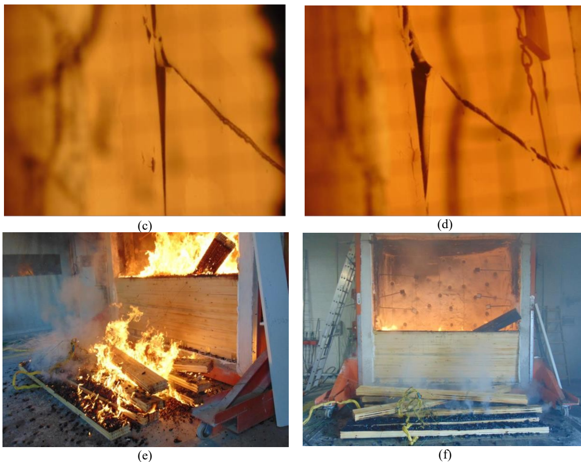
Slika 4.111 Ispitni uzorak – izložena strana: (a) 4. minuta ispitivanja; (b) 13. minuta ispitivanja; 34. minuta ispitivanja; (d) 45. minuta ispitivanja; (e) 90. minuta - pad kriterija nosivosti i cjelovitosti; (f) 91. minuta - prekid ispitivanja
