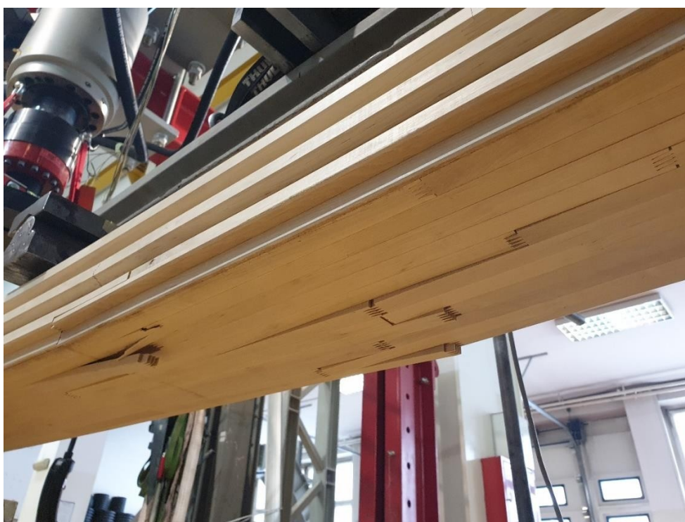
Slika 3.41 Savijanje oko slabije osi- pucanje tvrdog drva po zupčastom spoju
