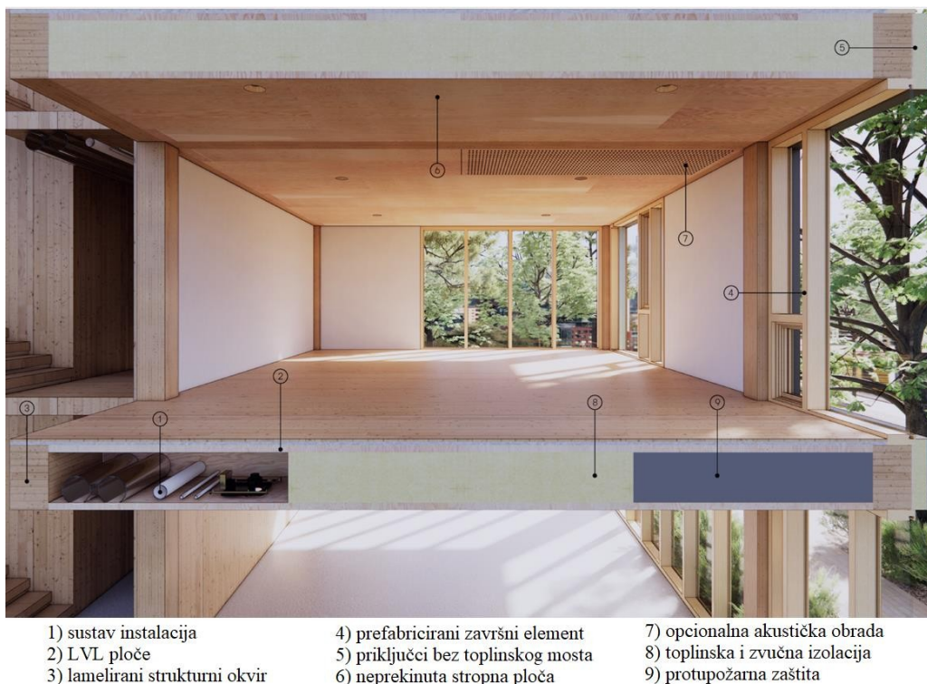
Slika 2.14 Dijelovi sustava Fabric
