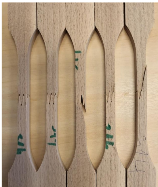
Slika 4.88 Ispitivanje vlačne čvrstoće pri ambijentnim uvjetima - karakteristični modovi loma
