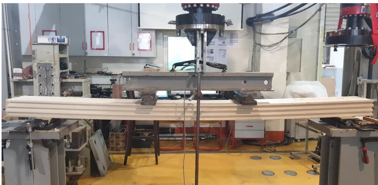
Slika 3.39 Ispitivanje grede savijanjem oko slabije osi
