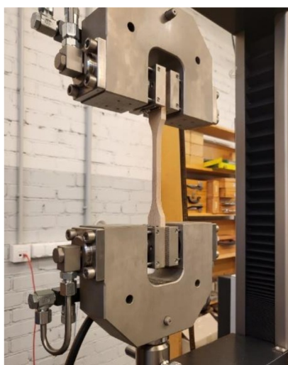
Slika 3.61 Ispitivanje vlačne čvrstoće paralelno s vlakancima – postavke ispitivanja
