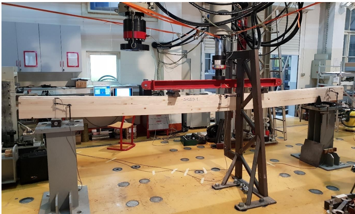
Slika 3.5 Ispitivanje uzoraka savijanjem oko jače osi - položaj na preši
