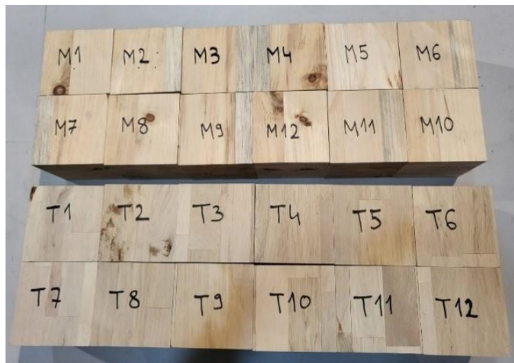
Slika 3.34 Uzorci za ispitivanje gustoće i vlage
