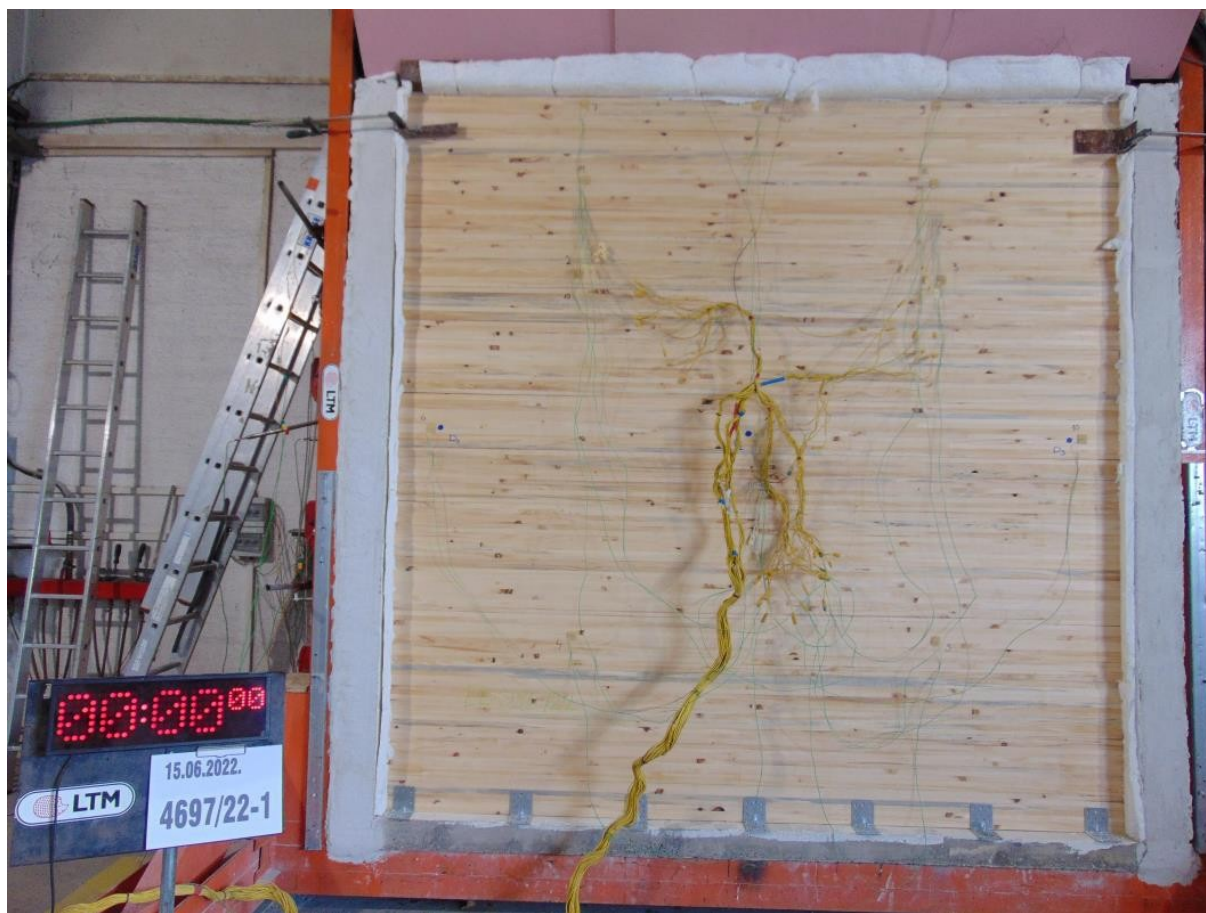
Slika 4.110 Ispitni uzorak s neizložene strane prije ispitivanja
