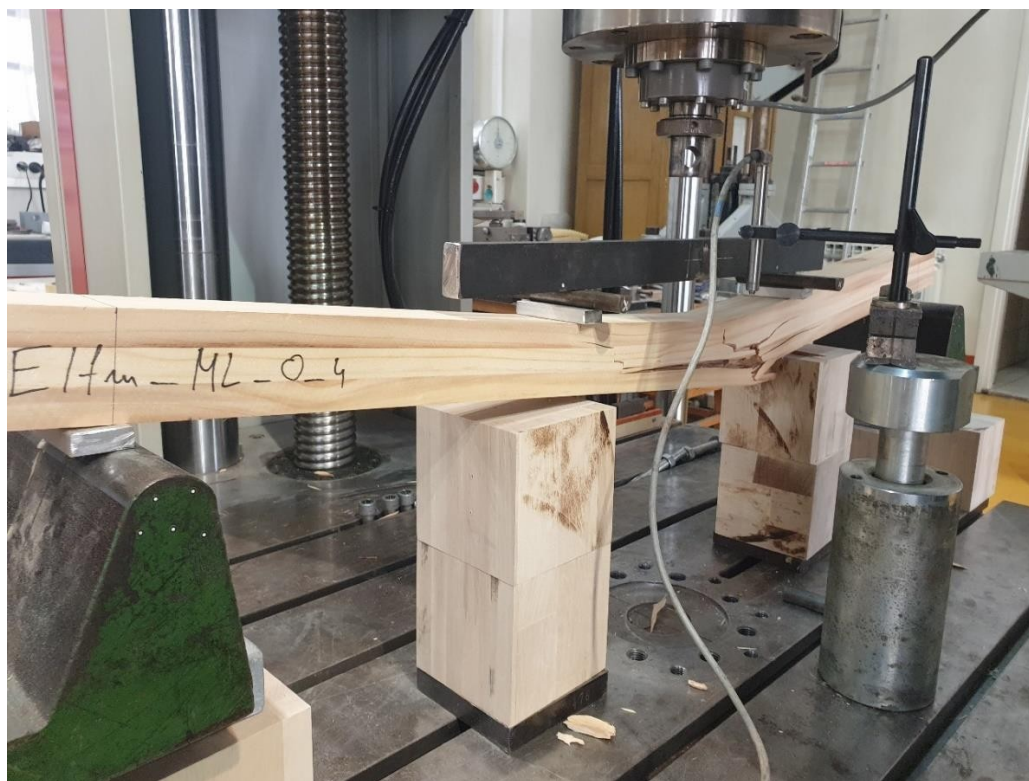
Slika 3.33 Slom uzorka i kraj ispitivanja – uzorak 60×60 mm
