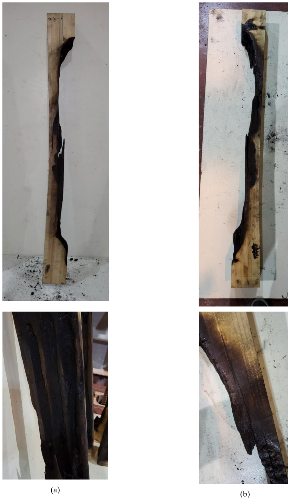
Slika 4.18 Prošupljena greda sa prvom punom lamelom: (a) K501; (b) K.510
