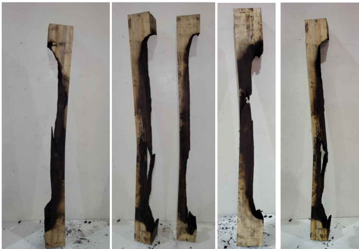
Slika 4.15 Modovi loma prošupljenih uzoraka
