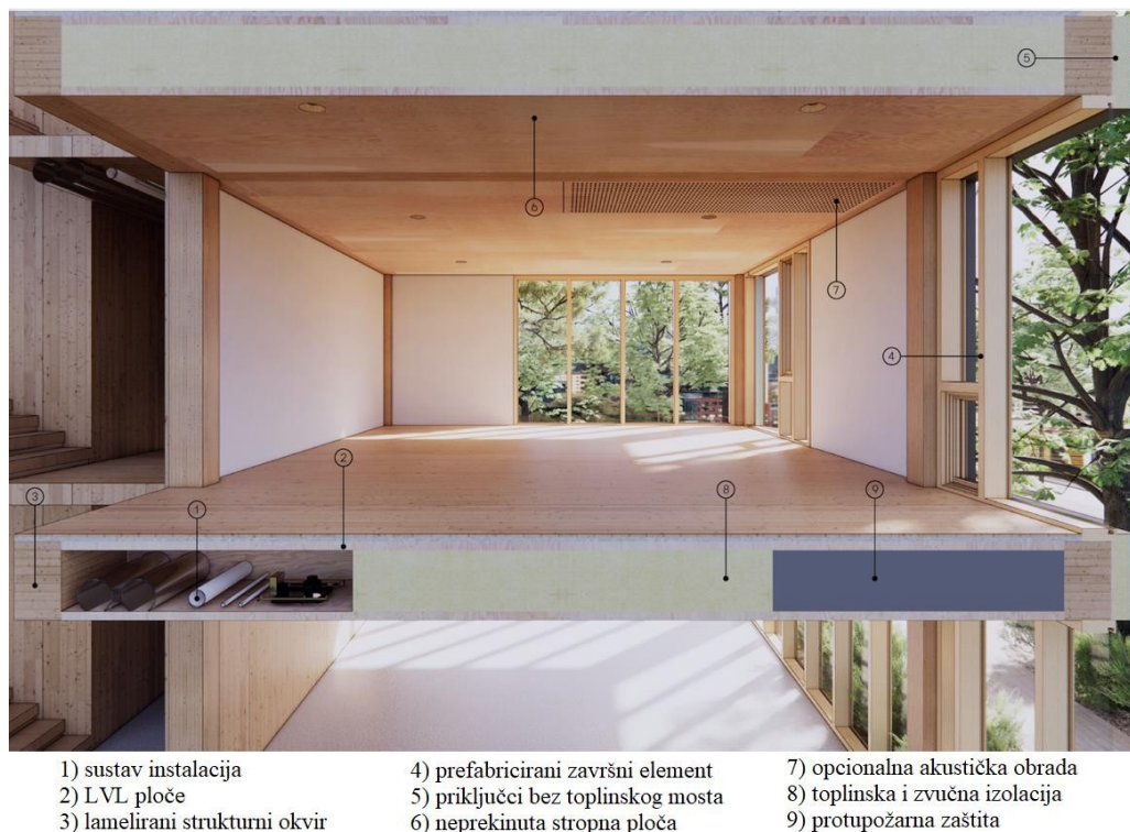
Slika 2.14 Dijelovi sustava Fabric
