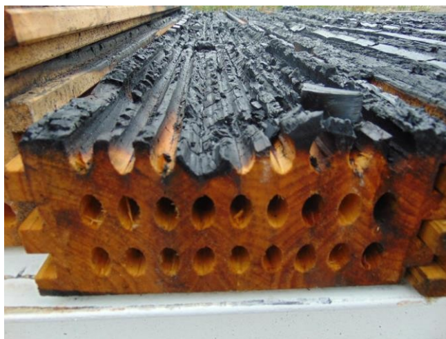
Slika 4.112 Presjek prošupljenog laminiranog drvenog elementa nakon ispitivanja
