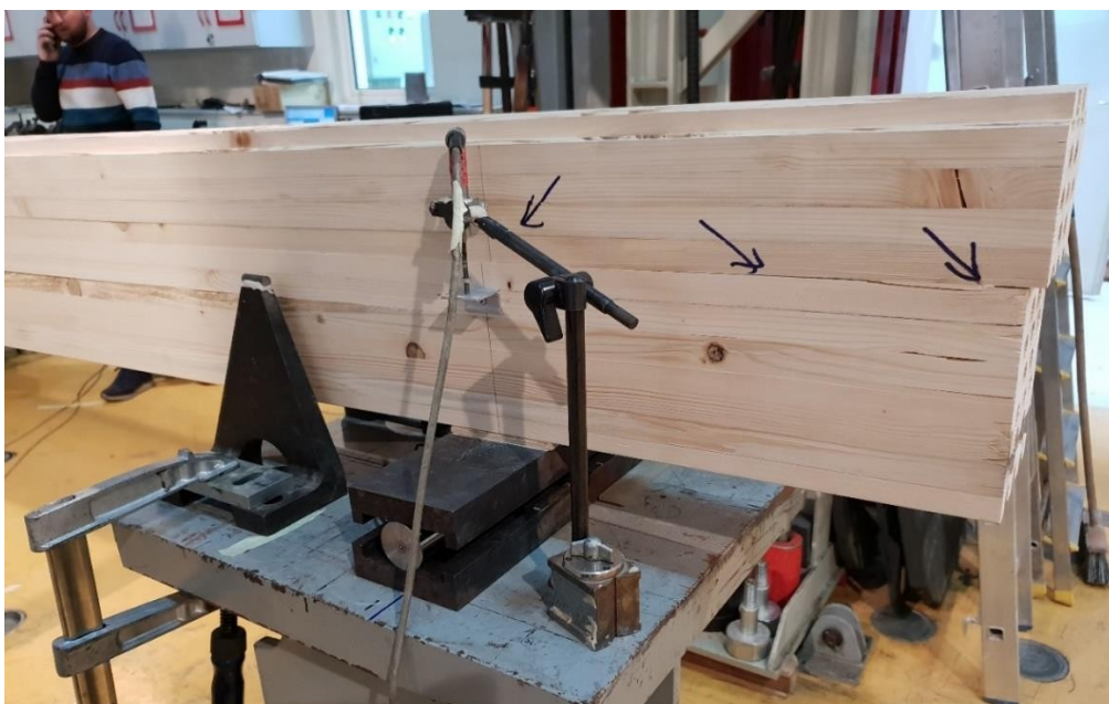
Slika 3.10 Otkazivanje uzorka SK(0) - 1 uzdužno po ljeplju s naznačenim ravninama sloma
