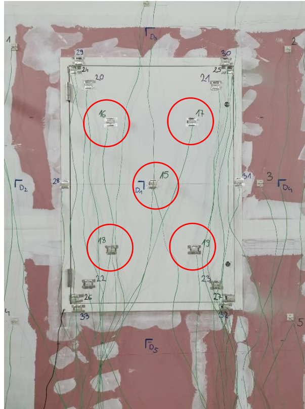
Slika 13. Postava termoparova za mjerenje prosječne temperature na neizloženoj strani uzorka
