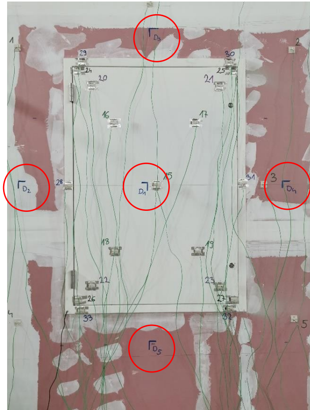
Slika 24. Pozicije za mjerenje deformacija uzorka
