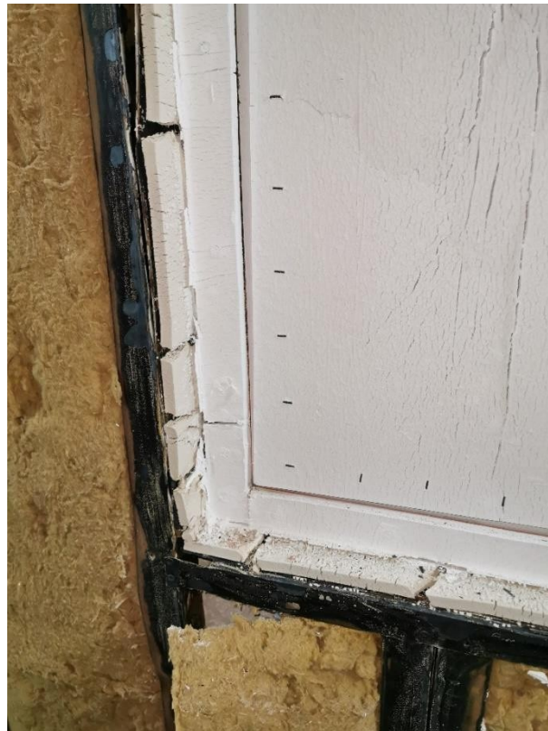
Slika 43. Izgled materijala nakon ispitivanja otpornosti na požar
