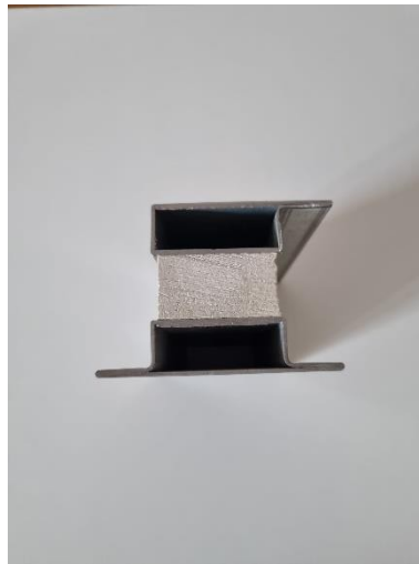
Slika 5. Čelični profil ispunjen kalcij silikatnom pločom
