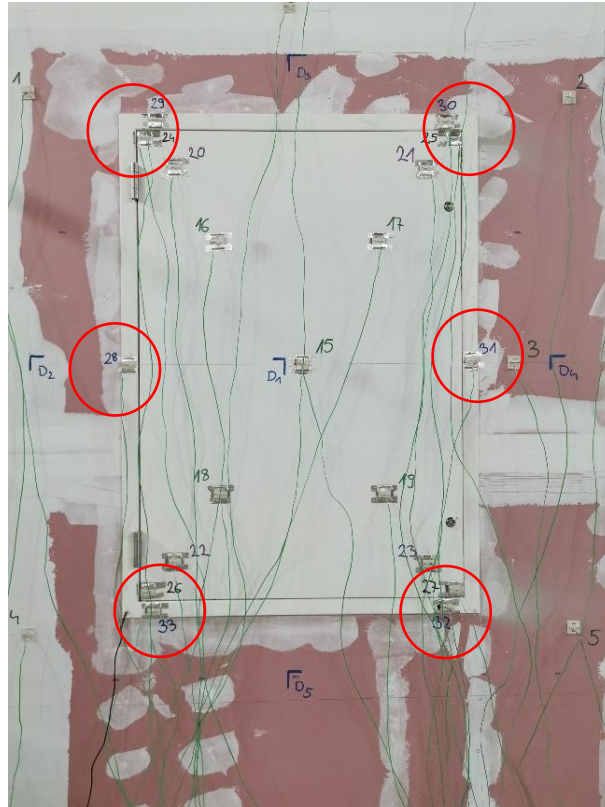
Slika 14. Postava termoparova za mjerenje maksimalne temperature okvira vrata na neizloženoj strani uzorka
