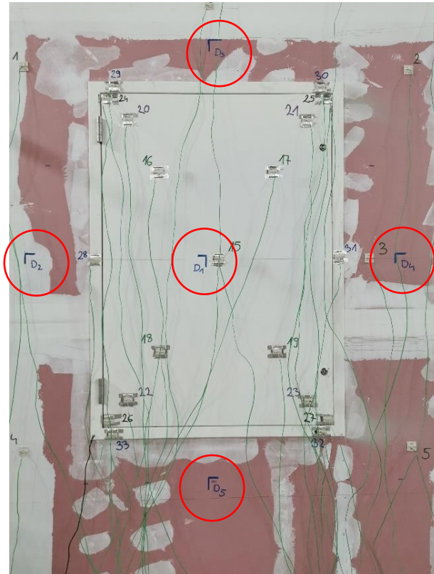
Slika 24. Pozicije za mjerenje deformacija uzorka
