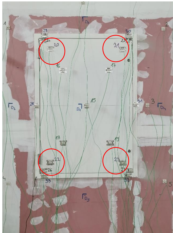
Slika 15. Postava termoparova za mjerenje maksimalne temperature vratnog krila na neizloženoj strani uzorka
