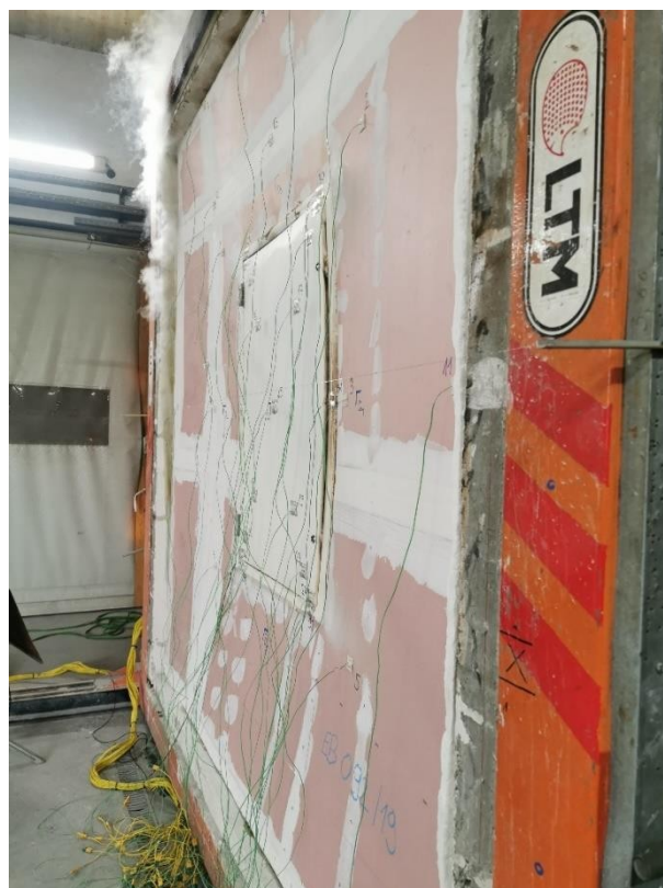
Slika 27. Deformacije požarnih revizijskih vrata
